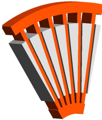
FIGURE 4.3 – Encoches ouvertes
