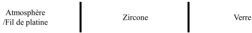
Figure II - 9 : Chaîne électrochimique de l'électrode de référence en zircone yttrée.
