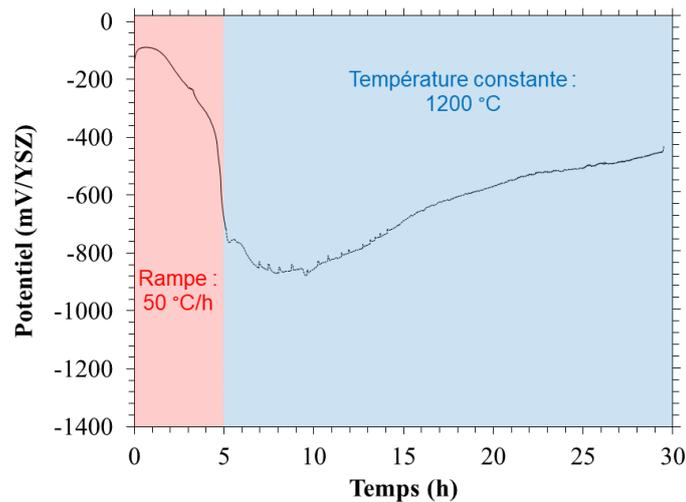
**Figure III - 3 : Evolution du potentiel de corrosion de l'alliage Ni-30Cr lors d'un essai de dépassivation, température d'immersion : 942 °C, durée de pré-oxydation : 64 h et rampe de température : 50 °C/h. Arrêt de la rampe de température à un potentiel de -800 mV/YSZ et maintien de la température à 1200 °C.**
