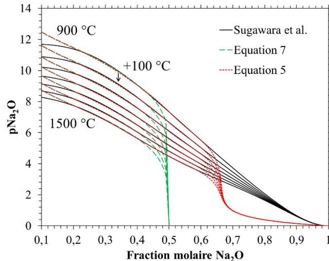
Figure IV - 1 : Evolution de  $p\text{Na}_2\text{O}$  en fonction de la composition d'un liquide binaire  $\text{Na}_2\text{O}$ - $\text{SiO}_2$ . Valeurs données par Sugawara *et al.* [12] et par les Equation IV - 5 et 7 après minimisation des écarts quadratiques.
