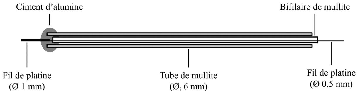
Figure II - 5 : Schéma d'une électrode de travail en platine.
