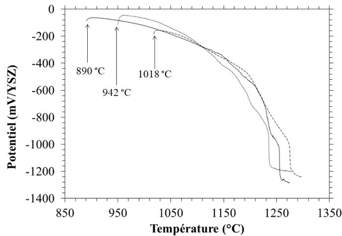
**Figure III - 11 : Evolution du potentiel de corrosion de l'alliage Ni-30Cr immergé dans 0,75NB2,75S pour trois températures d'immersion (890, 942 et 1018 °C), une rampe de température de 50 °C/h et une pré-oxxydation de 64 h à 942 °C.**
