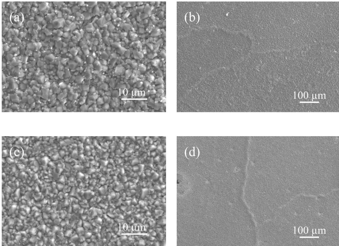
**Figure III - 1 : Micrographies MEB (mode SE) des échantillons oxydés sous air, (a) et (b) 40 h à 950 °C, (c) et (d) 7 h 15 min à 1050 °C.**
