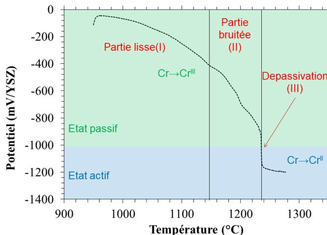
**Figure III - 2 : Evolution du potentiel de corrosion de l'alliage Ni-30Cr lors d'un essai de dépassivation, température d'immersion : 942 °C, durée de pré-oxydation : 64 h et rampe de température : 50 °C/h.**
