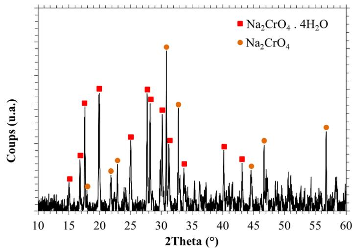
Figure III - 18 : Diffractogramme de la phase  $\text{Cr}^{\text{VI}}$ .
