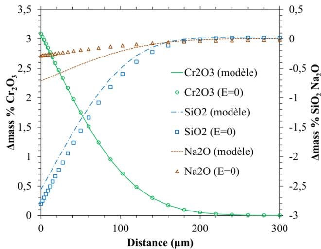
**Figure IV - 8 : Profils de concentration en Cr<sub>2</sub>O<sub>3</sub>, Na<sub>2</sub>O et SiO<sub>2</sub> simulés avec calcul du champ électrique (modèle) et sans (E=0) dans (Na<sub>2</sub>O)<sub>0.25</sub>(SiO<sub>2</sub>)<sub>0.75</sub> à 1150 °C.**
