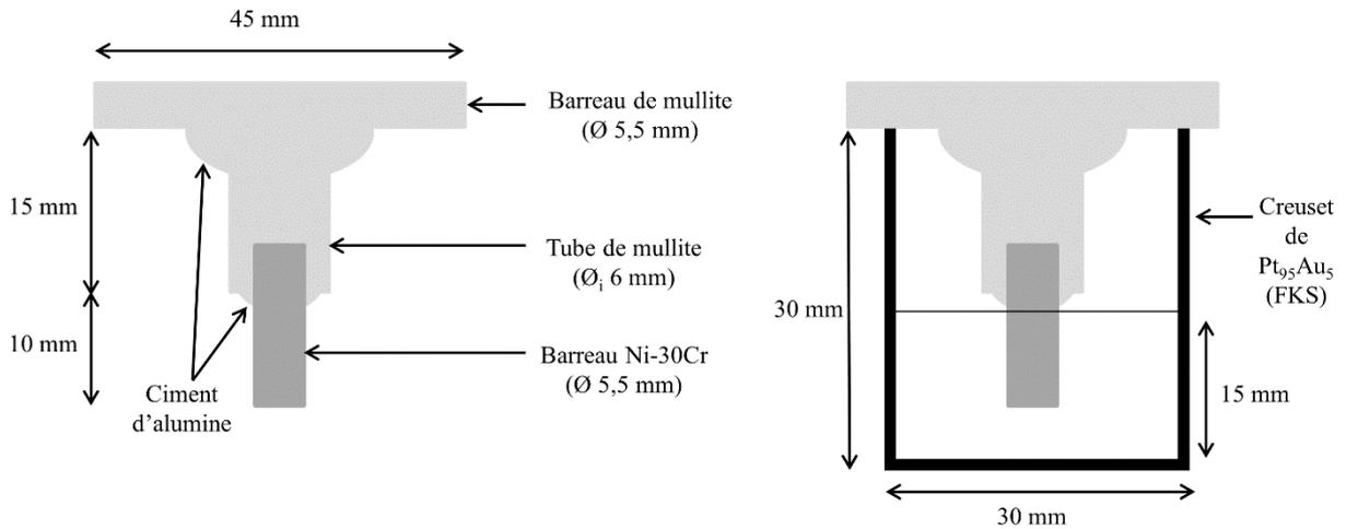
Figure II - 12 : Schéma du montage utilisé pour l'étude de la dissolution de la chromine.
