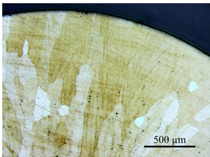
Figure II - 2 : Vue en section d'un barreau d'alliage Ni-30Cr après attaque chimique (HCl/H<sub>2</sub>O<sub>2</sub> 95/5) au microscope optique.
