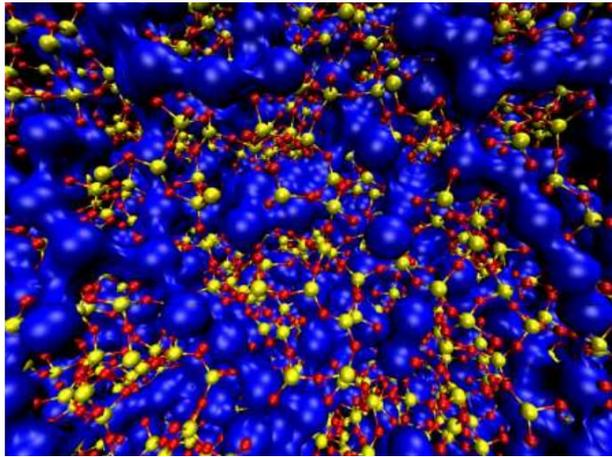
Figure I - 4 : Structure d'un verre Na<sub>2</sub>O-SiO<sub>2</sub> calculée par dynamique moléculaire [13]. Oxygène en rouge ; silicium en jaune et canaux formés par les ions sodium en bleu.
