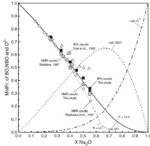
Figure I - 7 : Répartition des BO, NBO et O<sup>2-</sup> dans les verres Na<sub>2</sub>O-SiO<sub>2</sub> donnée par Nesbitt *et al.* [15].
