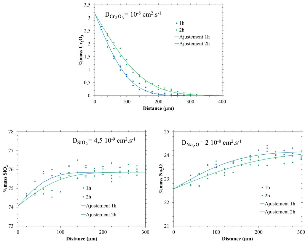
Figure IV - 17 : Profils de concentration en  $\text{Cr}_2\text{O}_3$ ,  $\text{SiO}_2$  et  $\text{Na}_2\text{O}$  après 1 et 2 h d'immersion dans  $(\text{Na}_2\text{O})_{0.25}(\text{SiO}_2)_{0.75}$  de l'alliage Ni-30Cr pré-oxydé 24 h à 1150 °C.
