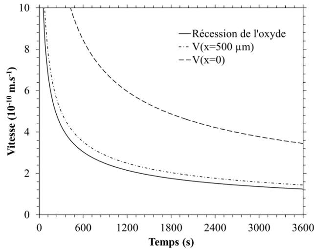
Figure IV - 12 : Evolution du champ de vitesse en fonction du temps à différentes positions dans le liquide au cours de la simulation (1h,  $(\text{Na}_2\text{O})_{0.25}(\text{SiO}_2)_{0.75}$ , 1150 °C).
