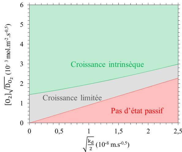
Figure V - 10 : Diagramme de corrosion d'un alliage chromino-formeur,  $k_p = 5 \cdot 10^{-16} \text{ m}^2.\text{s}^{-1}$ , sans prendre en compte la formation de  $\text{Cr}^{\text{VI}}$  ( $P = 1$ ).
