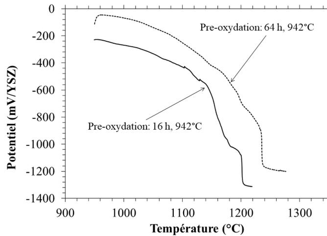
Figure III - 10 : Evolution du potentiel de corrosion de l'alliage Ni-30Cr immergé dans 0,75NB2,75S pour les deux conditions de pré-oxydation (64 h et 16 h à 942 °C) avec une même rampe de température (50 °C/h) et une même température d'immersion (942 °C).
