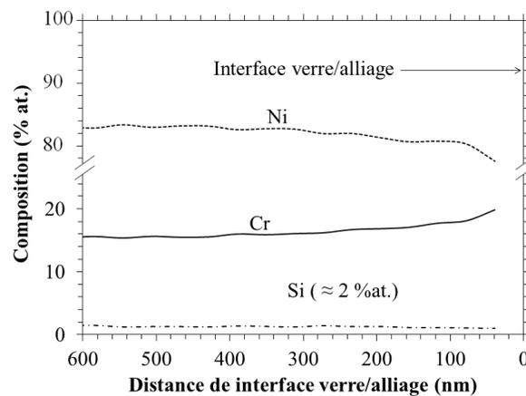
Figure III - 7 : Profils de concentration en Ni, Cr et Si en subsurface de l'alliage dépassivé (f).
