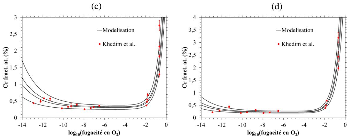
Figure IV - 4 : Courbes de solubilités du chrome en fonction de la fugacité en oxygène pour différentes températures et composition de liquide Na<sub>2</sub>O-SiO<sub>2</sub> ; (a) : 0,250 ; (b) : 0,287 ; (c) : 0,333 ; (d) : 0,400 fraction molaire en Na<sub>2</sub>O. Lignes noires : modélisation de ce travail ; points rouges : résultats expérimentaux de Khedim et al. [18].
