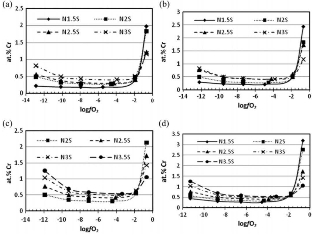
Figure I - 15 : Courbes de solubilité du chrome dans le système binaire Na<sub>2</sub>O-SiO<sub>2</sub> en fonction de la fugacité en O<sub>2</sub> pour (a) 1125 °C, (b) 1175 °C, (c) 1200 °C et (d) 1250 °C [88].
