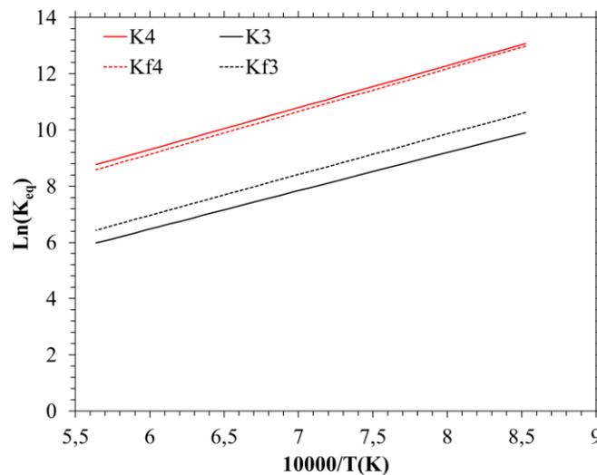
**Figure IV - 2 : Evolution des constantes de réaction en fonction de la température sous forme de diagramme d'Arrhenius (ligne : Equation 5 ; pointillés : FactSage [15]).**
