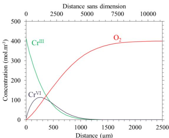
Figure V - 1 : Profils de concentration en Cr<sup>III</sup>, Cr<sup>VI</sup> et O<sub>2</sub> dans N3S à 1150 °C après 1000 t̂ (27,8 h).
