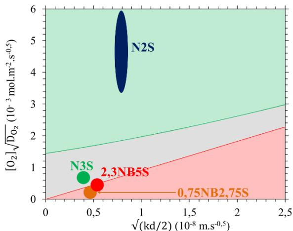
Figure V - 11 : Diagramme de corrosion d'un alliage chromino – formeur,  $k_p = 5 \cdot 10^{-16} \text{ m}^2.\text{s}^{-1}$ , dans le cas général  $P = 1$ . Placement des quatre liquides silicatés sous air ( $P_{\text{O}_2} = 0,2 \text{ atm}$ ) à  $1150 \text{ }^\circ\text{C}$ .
