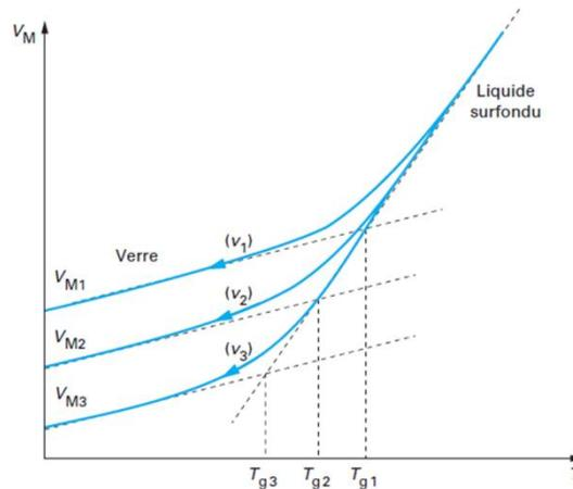
**Figure I - 2 : Evolution schématique du volume molaire avec la température pour une phase vitreuse pour différentes vitesses de refroidissement ( $v_1$ ,  $v_2$  et  $v_3$ ) conduisant à différentes températures de transition vitreuse ( $T_{g1}$ ,  $T_{g2}$  et  $T_{g3}$ ) [3].**
