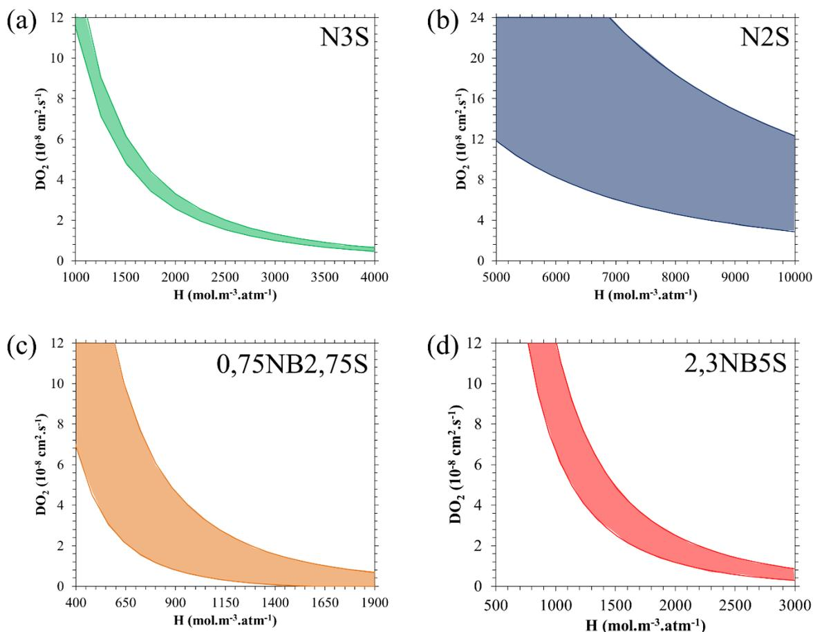
Figure V - 9 : Couples de valeur de diffusivité et constante de Henry pour  $\text{O}_2$  possible pour les compositions (a) : N3S ; (b) : N2S ; (c) : 0,75NB2,75S et (d) : 2,3NB5S. Valeurs obtenues par dosage indirect de  $\text{O}_2$  par les ions Cr.
