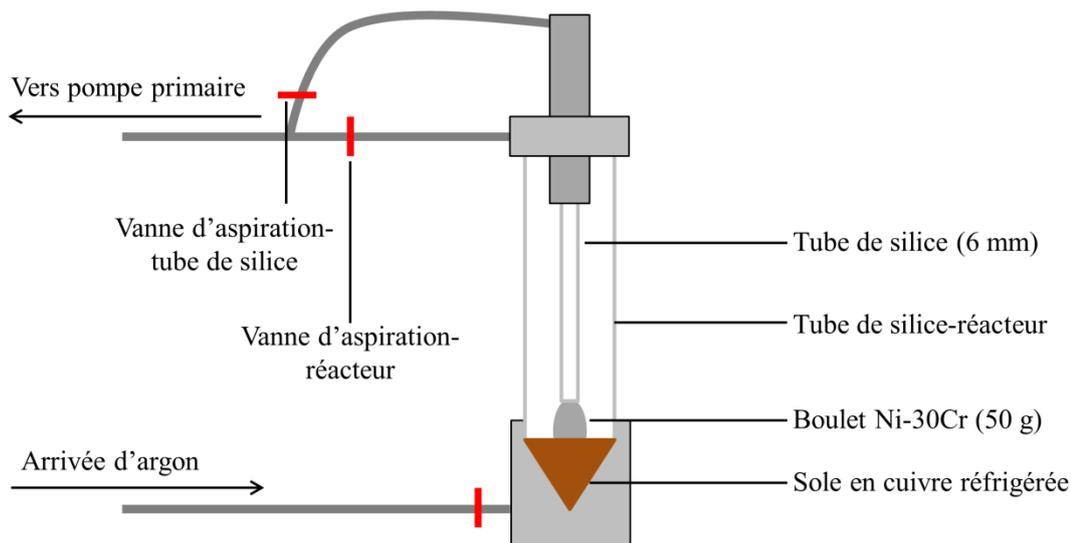
Figure II - 1 : Schéma du montage de fusion haute fréquence utilisé pour l'élaboration des barreaux d'alliage Ni-30Cr.
