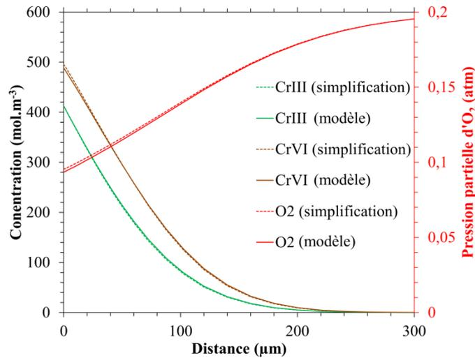
Figure IV - 19 : Profils de concentration du Cr<sup>III</sup>, Cr<sup>VI</sup> et O<sub>2</sub> prédit par le modèle complet (modèle) et par la version simplifiée (simplification) développée dans cette dernière section.
