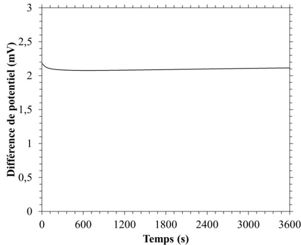
Figure IV - 10 : Evolution de la différence de potentiel entre le cœur du liquide  $(\text{Na}_2\text{O})_{0.25}(\text{SiO}_2)_{0.75}$  et l'interface liquide/chromine en fonction du temps lors de la simulation.
