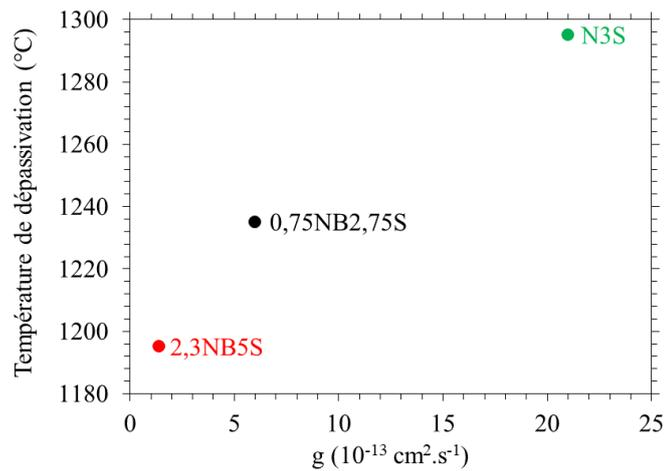
**Figure III - 13 : Evolution de la température de dépassivation (pré-oxydation : 64 h à 942 °C ; immersion : 942 °C ; rampe de température : 50 C°/h) en fonction de la constante de croissance globale de l'oxyde à 1150 °C [11].**
