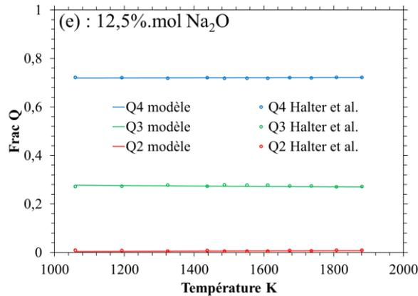
**Figure IV - 3 : Evolution de la répartition en Q<sup>n</sup> dans des liquides binaires Na<sub>2</sub>O-SiO<sub>2</sub>, mesurée par Halter *et al.* [14] (cercles creux) et prédite par l'Equation 6 (lignes) pour une fraction molaire de Na<sub>2</sub>O de (a) : 0,333 ; (b) : 0,250 ; (c) : 0,200 ; (d) : 0,167 et (e) : 0,125.**
