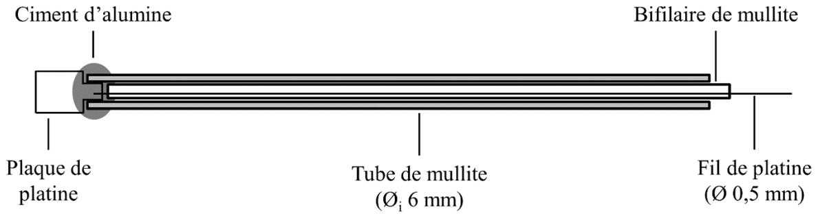
Figure II - 8 : Schéma d'une contre électrode en platine.
