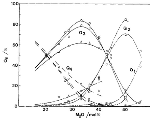
Figure I - 6 : Répartition des Q<sup>n</sup> dans les systèmes M<sub>2</sub>O-SiO<sub>2</sub> donnée par Maekawa *et al.* [16]. M = Li (Δ), Na (□) et K (O).
