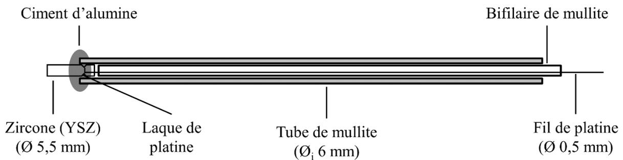
Figure II - 7 : Schéma d'une électrode de référence en zircon.
