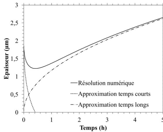
Figure I - 21 : Comparaison entre la résolution numérique (Equation I – 44), l'approximation aux temps court (Equation I – 49) et l'approximation aux temps long (Equation I – 47 – 48) :  $k_p = k_d = 5 \cdot 10^{-12} \text{ cm}^2 \cdot \text{s}^{-1}$ , pré-oxyde = 2 µm.
