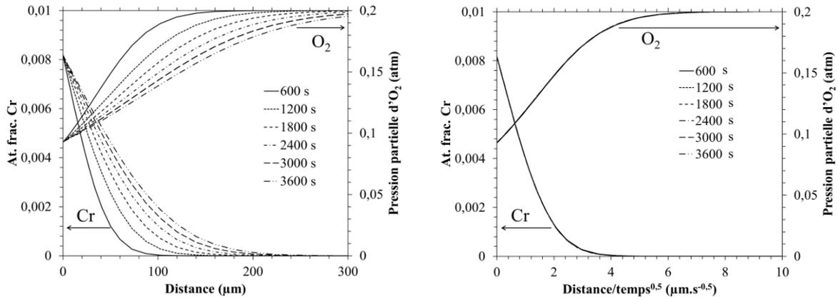
Figure IV - 16 : Profils de concentration en Cr et O<sub>2</sub> dans le liquide silicaté pour différentes durées de la simulation dans (Na<sub>2</sub>O)<sub>0.25</sub>(SiO<sub>2</sub>)<sub>0.75</sub> à 1150 °C. Représentation en fonction de la distance à gauche et en fonction de la distance par racine du temps à droite.
