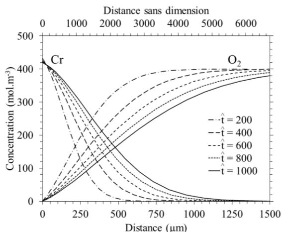
Figure V - 2 : Profils de concentration en Cr et O<sub>2</sub> dans N3S à 1150 °C à différents temps de simulation.
