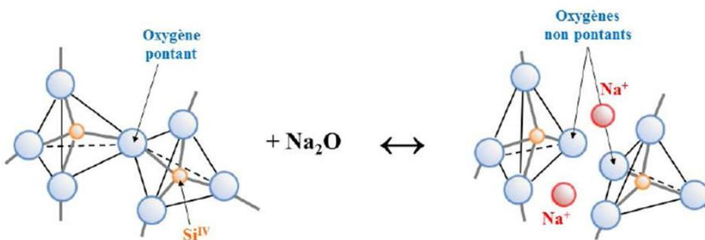
Figure I - 3 : Schémas de la dépolymérisation de la silice par l'oxyde de sodium [7].
