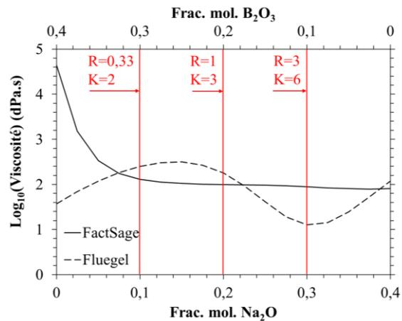
Figure I - 11 : Evolution de la viscosité dans le système  $\text{Na}_2\text{O-B}_2\text{O}_3\text{-SiO}_2$  à  $1150\text{ °C}$  pour une quantité constante de  $\text{SiO}_2$  (60 %) d'après Fluegel [43] : pointillés, et FactSage [44] : traits pleins.
