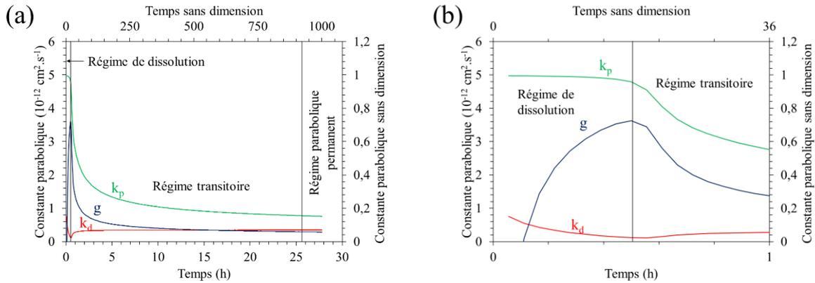
Figure V - 4 : Evolution des grandeurs paraboliques avec le temps pour l'alliage Ni-30Cr immergé dans le liquide N3S à 1150 °C. (a) : sur 30 h ; (b) sur les premiers instants.
