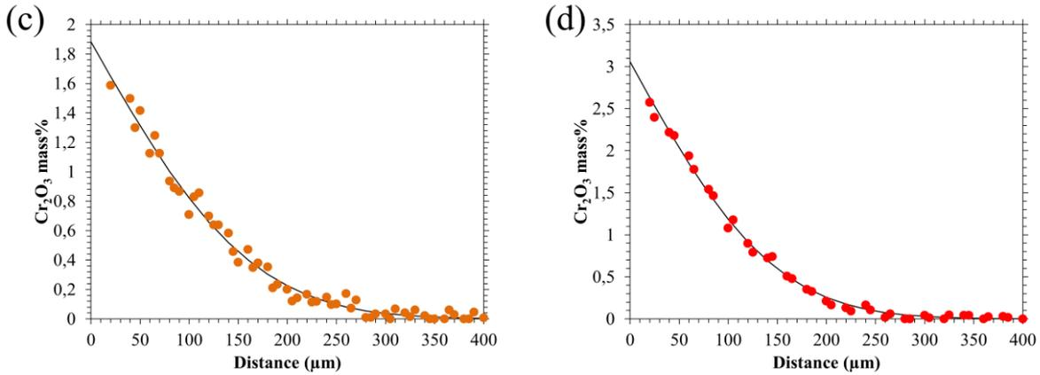
**Figure V - 8 : Profils en Cr<sub>2</sub>O<sub>3</sub> après 1 h d’immersion de l’alliage Ni-30Cr pré-oxydé 24 h à 1150 °C. (a) : N3S ; (b) : N2S ; (c) : 0,75NB2,75S ; (d) : 2,3NB5S. Points : mesures ; ligne noire : ajustement de la loi de diffusion.**
