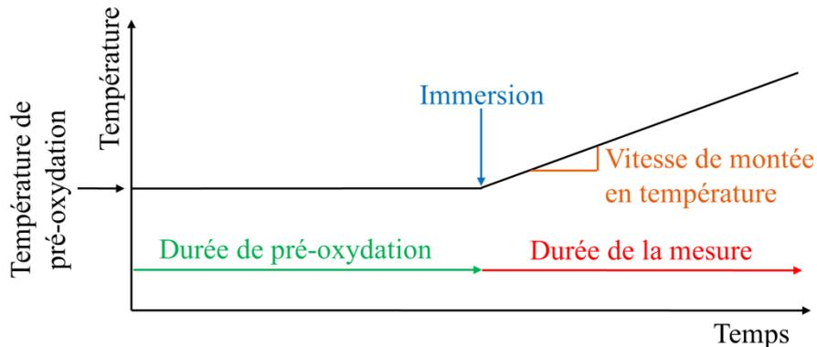
Figure II - 11 : Schéma du protocole des essais de dépassivation.
