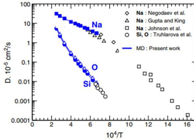
Figure I - 12 : Coefficients de diffusion de Na, Si et O dans un liquide  $33\text{Na}_2\text{O}-67\text{SiO}_2$ , d'après Bauchy *et al.* [38] (present work en bleu). Negodaev *et al.* [54], Gupta and King [55], Johnson *et al.* [56], Truhlarova *et al.* [57].
