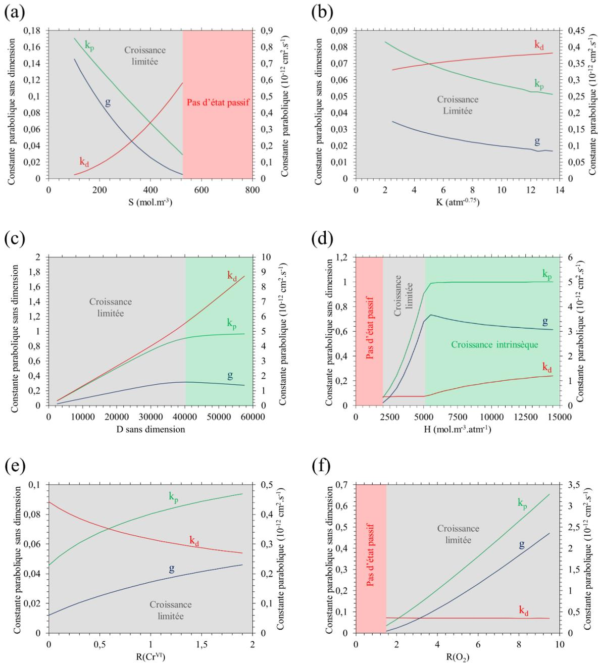
Figure V - 5 : Evolution des grandeurs paraboliques avec les six paramètres ; (a) :  $S$  ; (b) :  $K$  ; (c) :  $\hat{D}$  ; (d) :  $\text{H}_{\text{O}_2}$  ; (e) :  $R^{\text{Cr}^{\text{VI}}}$  ; (f) :  $R^{\text{O}_2}$  (valeurs de références dans le Tableau V – 1).
