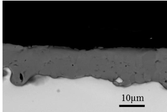
**Figure III - 9 : Micrographies MEB en mode BSE de l'interface verre/oxyde/alliage de l'échantillon trempé lors d'un essai de dépassivation, température d'immersion : 942 °C, durée de pré-oxydation : 64 h et rampe de température : 10 °C/h.**
