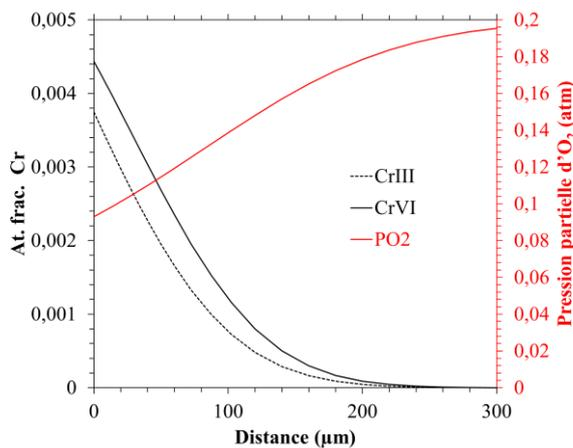
**Figure IV - 6 : Profils de diffusion du  $\text{Cr}^{\text{III}}$ ,  $\text{Cr}^{\text{VI}}$  et  $\text{O}_2$  après 1h de simulation. Dissolution de la chromine dans  $(\text{Na}_2\text{O})_{0.25}(\text{SiO}_2)_{0.75}$  à  $1150 \text{ }^\circ\text{C}$ .**
