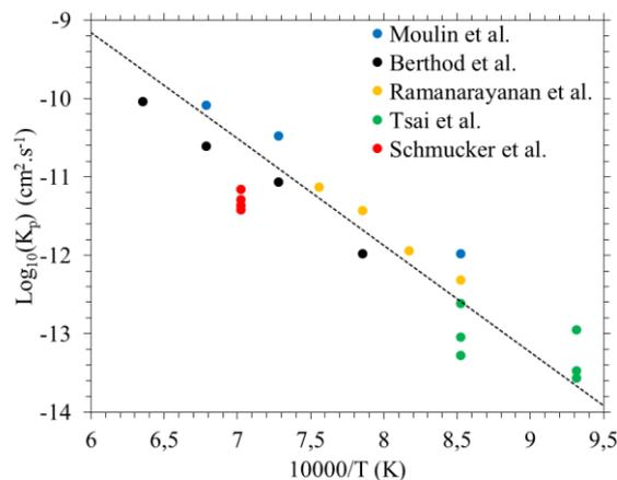
Figure I - 18 : Valeurs de  $k_p$  pour l'alliage Ni-30Cr issues de la littérature (ligne noire : ajustement linéaire). Moulin *et al.* [107], Berthod *et al.* [108], Ramanarayanan *et al.* [103], Tsai *et al.* [104] et Schmucker *et al.* [98].
