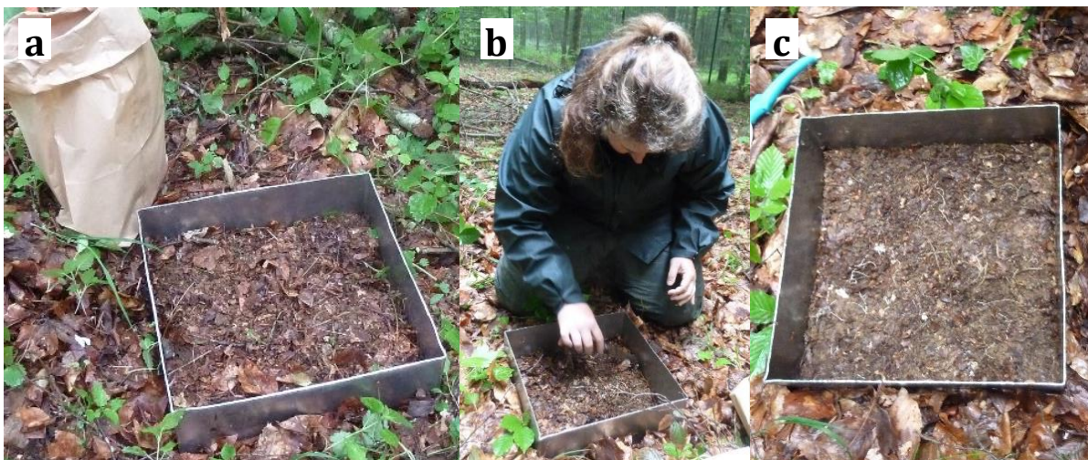
Figure 14: a- Cadre calibré de 0.1\text{ m}^2 délimitant la zone de prélèvement; b- prélèvement de l'humus en triant au maximum le sol; c- zone du cadre après le prélèvement
