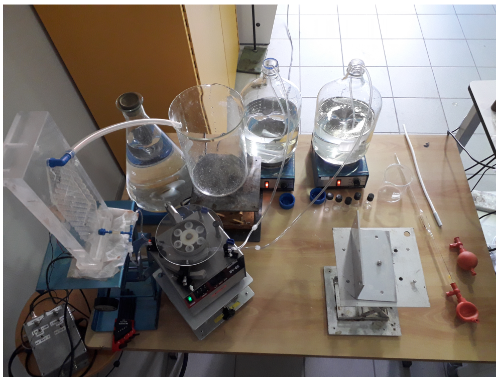
FIGURE 1.8 – Photo du banc expérimental pour les mesures d'avancement de réaction.
