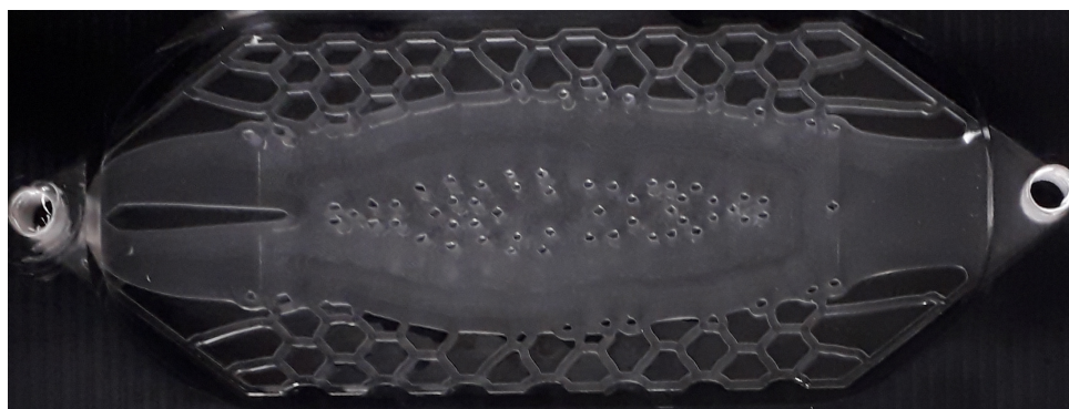
(b) Réacteur optimal R2 fabriqué par stratoconception ® .
