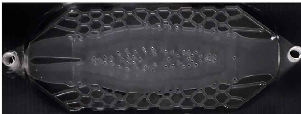
(b) Réacteur optimal  $R2$  fabriqué par stratoconception<sup>®</sup>.
