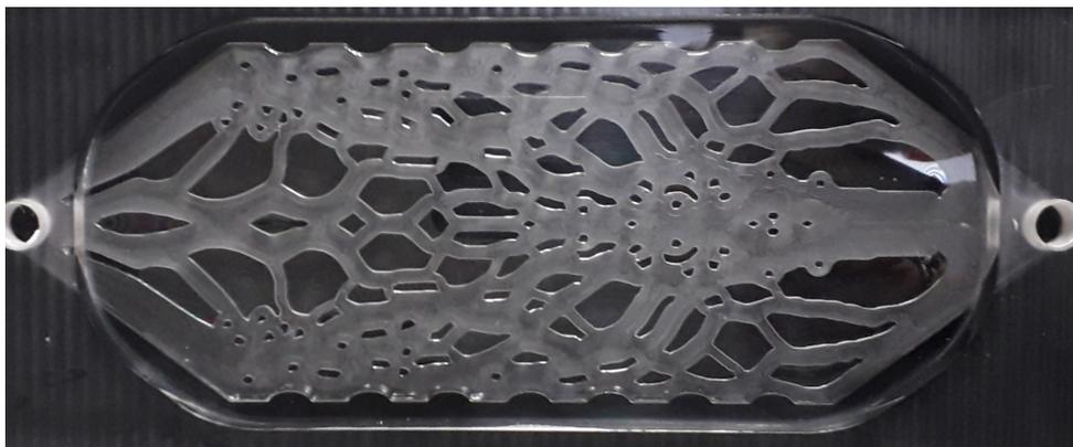
(b) Réacteur optimal  $R_4$  fabriqué par stratoconception<sup>®</sup>.
