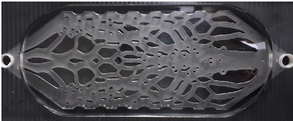
(b) Réacteur optimal fabriqué par stratoconception<sup>®</sup>.
