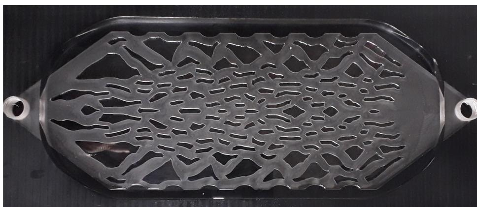
(b) Réacteur optimal  $R3$  fabriqué par stratoconception<sup>®</sup>.
