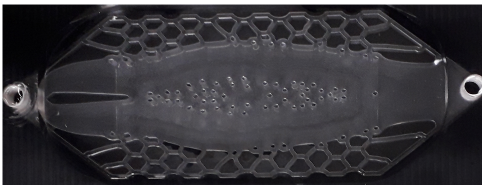
(b) Réacteur optimal R2 fabriqué par stratoconception ® .
