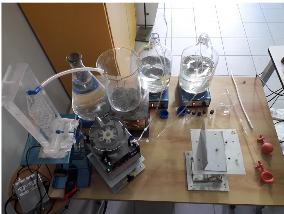
FIGURE 1.8 – Photo du banc expérimental pour les mesures d'avancement de réaction.
