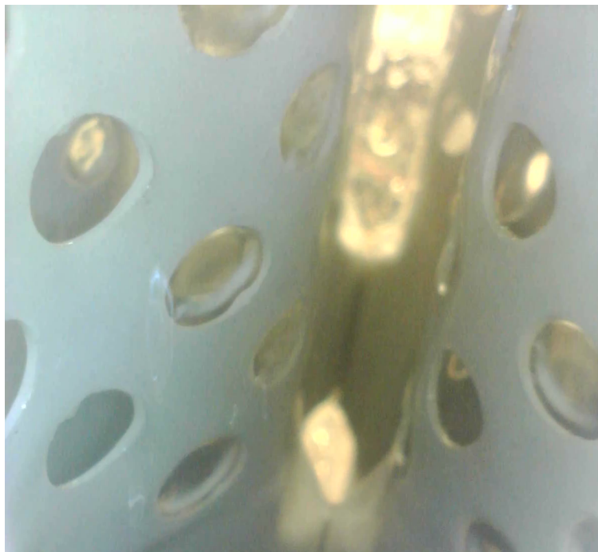
FIGURE 4.11 – Image obtenue avec la caméra endoscopique pour visualiser le film ruisselant et les lentilles d'eau formées dans les perforations
