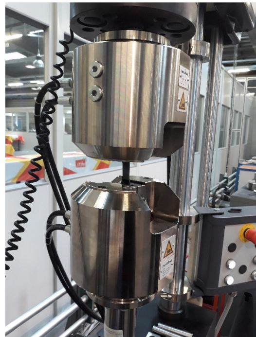
Figure 5.14 : Montage d'essais de fatigue sur un PPS/GF40
