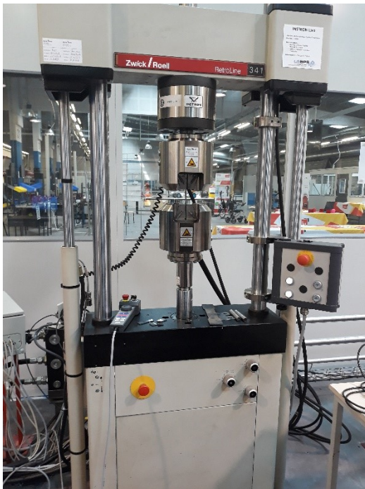
Figure 5.14 : Montage d'essais de fatigue sur un PPS/GF40
