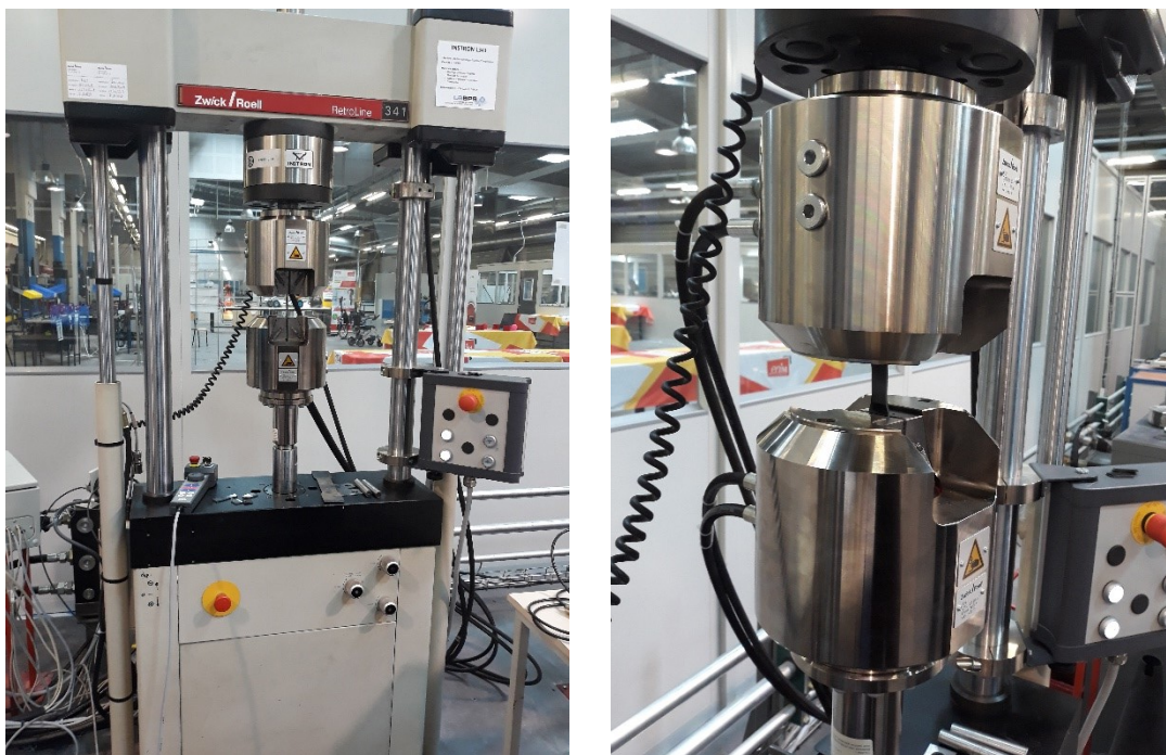
Figure 5.14 : Montage d'essais de fatigue sur un PPS/GF40
