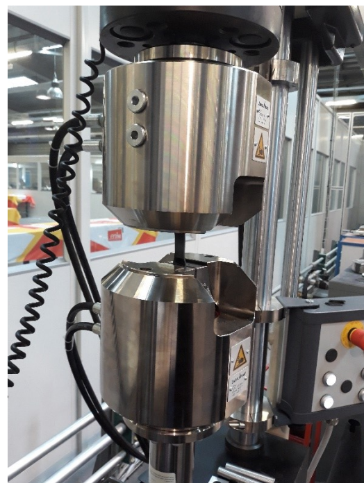
Figure 5.14 : Montage d'essais de fatigue sur un PPS/GF40
