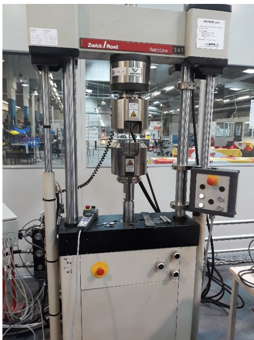
Figure 5.14 : Montage d'essais de fatigue sur un PPS/GF40
