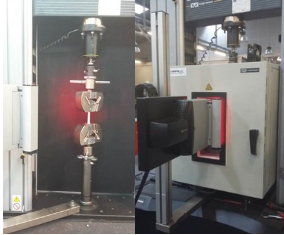
Figure 2.11 : Configuration d'essais de traction à température ambiante et dans une enceinte climatique
