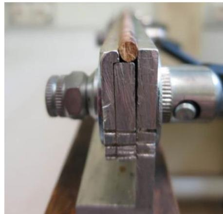
Figure 2. 3 : Photographies du planage lors de la préparation des carottes.
