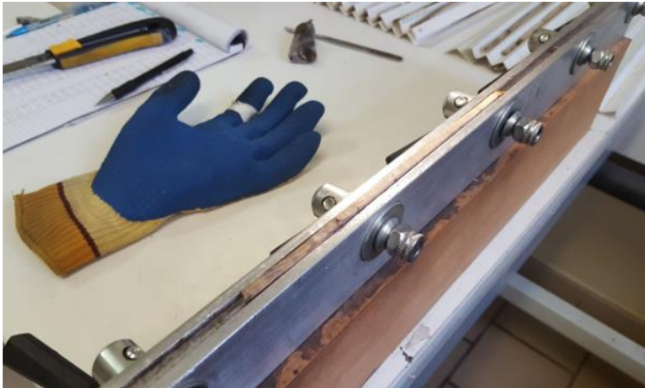
Figure 2. 3 : Photographies du planage lors de la préparation des carottes.
