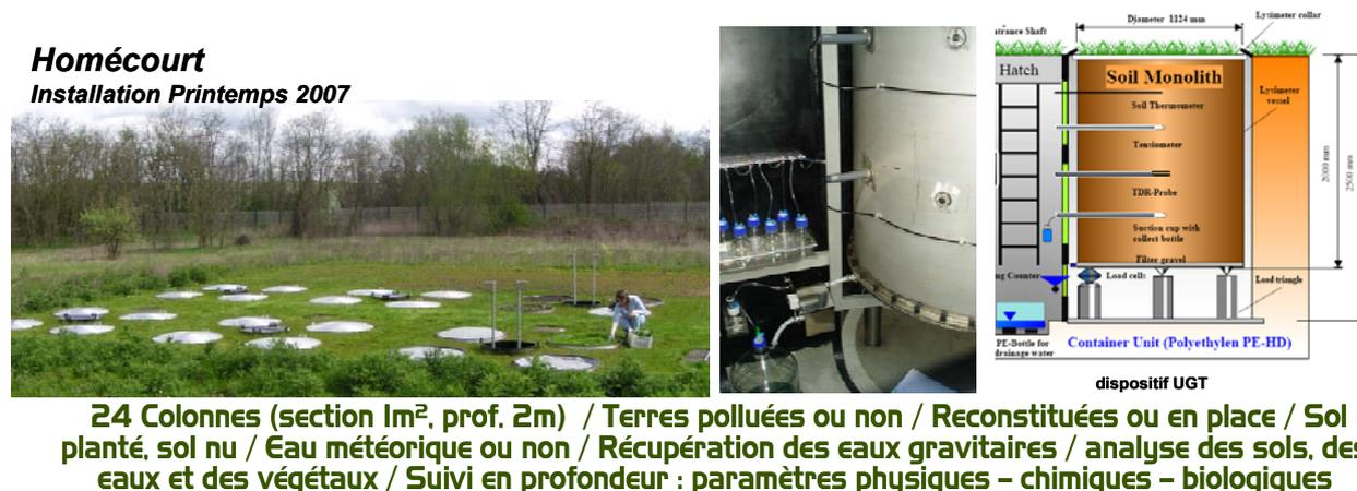
Figure 11.2 : Présentation du dispositif de colonnes lysimétrique installé sur l'ancien site de la cokerie de Homécourt (Meurthe et Moselle, France).
