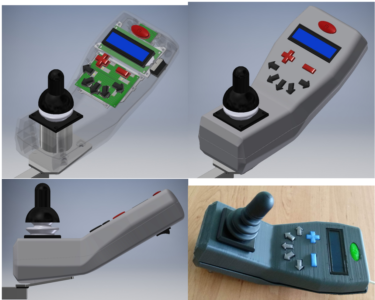
FIGURE 3.30 – Simulateur de conduite ViEW - Évolution de l'organe de commande : Conception d'un boîtier et de son électronique pour le simulateur ViEW.
