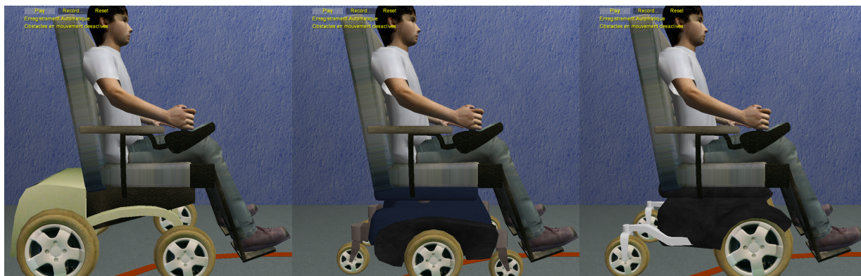
FIGURE 3.29 – Simulateur de conduite ViEW : architectures de fauteuil (propulsion, centrale et traction)
