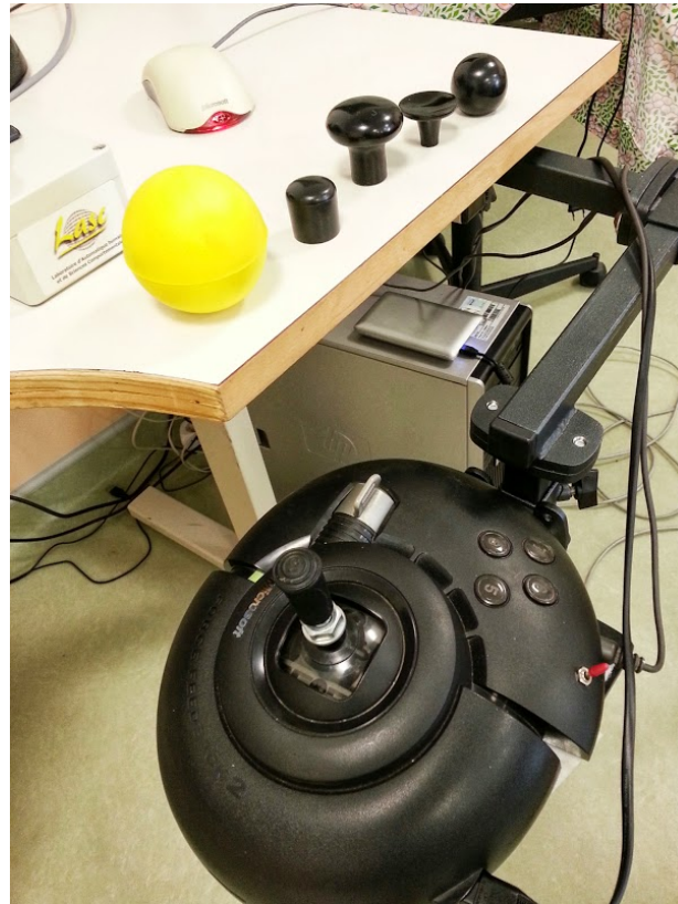
FIGURE 3.41 – Joystick à retour de force modifié
