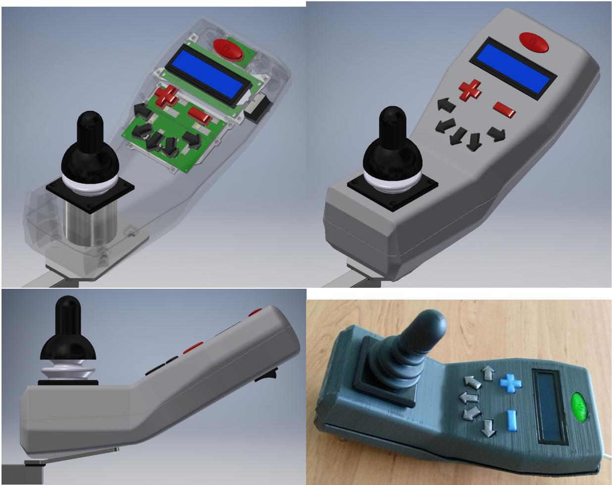
FIGURE 3.30 – Simulateur de conduite ViEW - Évolution de l'organe de commande : Conception d'un boîtier et de son électronique pour le simulateur ViEW.
