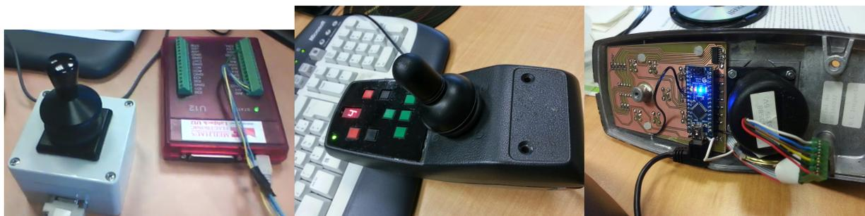
FIGURE 3.28 – Simulateur de conduite ViEW - Évolution de l'organe de commande : Joystick Penny & Giles et module d'acquisition Labjack U12, intégration dans un boîtier de joystick avec acquisition à base d'arduino.
