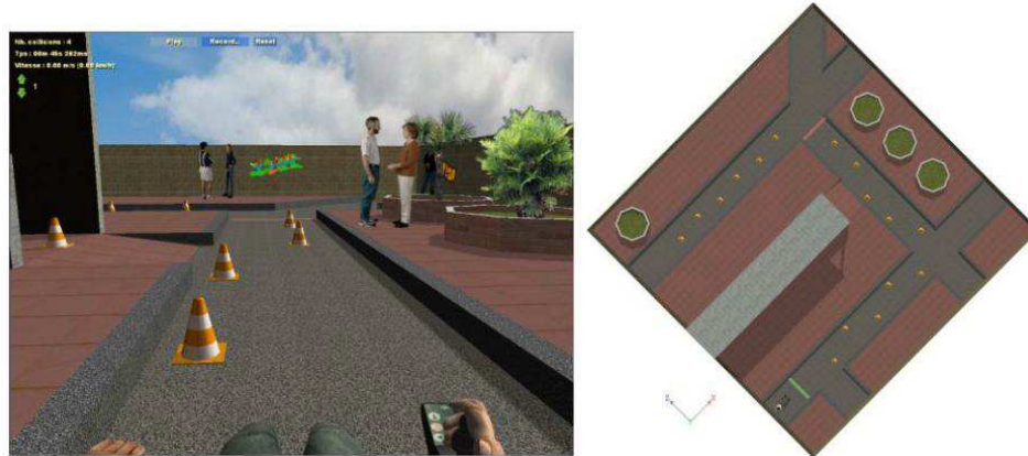
FIGURE 3.33 – Simulateur de conduite ViEW : vue embarquée 3D (à gauche) et vue externe 2D (à droite)
