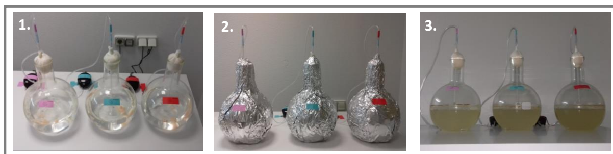
Figure III.5 : Photos des phases de production (1, 2) et de récupération (3) du consortium nitrifiant de seconde génération.
