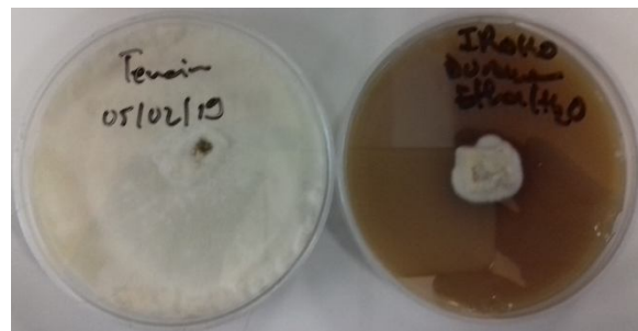
Figure 59 : Inhibition de croissance de Trametes Versicolor avec extrait de duramen d'Iroko
