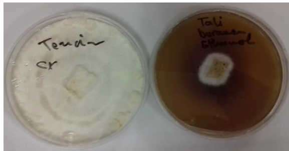
Figure 57 : Inhibition de croissance de Trametes Versicolor avec extrait de duramen de Tali
