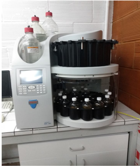
Figure 34 : Appareil et schéma du système d'extraction accélérée au Dionex (ASE)
