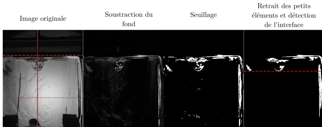
FIGURE 4.27 – Exemple de déroulement de la procédure d’analyse d’image pour le test référencé 621 – Re = 13\,000 , T_j = 48\text{ }^\circ\text{C} et D_j = 4,9\text{ mm} . Un seuil fixe de 30 a été utilisé et la limite de taille pour les éléments retirés était de 512 pixels. Sur la première image, l’axe d’analyse est représenté par une ligne verticale rouge, les lignes horizontales représentent dans l’ordre vertical descendant : la position de la surface, la position de la profondeur de cavité minimale détectable et la profondeur maximale de recherche de la cavité.
