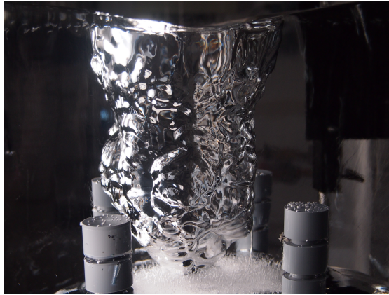
FIGURE 4.13 – Photographie de la cavité à la fin de l'essai 625 – Re = 109\,000 , T_j = 51\text{ }^\circ\text{C} et D_j = 6\text{ mm} . Des cupules dues à la fonte sont visibles.
