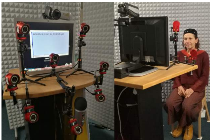
FIGURE 3.3 – Système de MoCap OptiTrack (caméra Flex 13) composé de 8 caméras. Ce système a été utilisé pour l'acquisition du corpus français et allemand.
