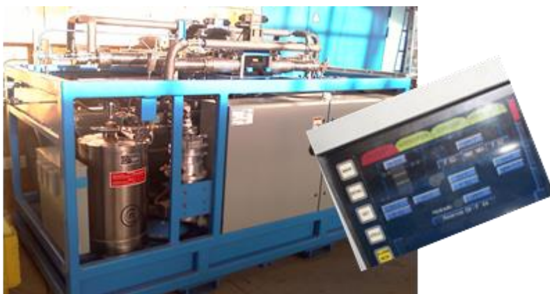
Photo du générateur de jet d'azote liquide haute pression intégré au CRITT TJFU en 2006
