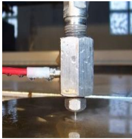
Figure 3 : A gauche - Photo de l'outil prototype micro-jet d'eau abrasif à basse pression développé pour le micro perçage des matériaux durs et fragiles. A droite - Photo du trou micronique réalisé par le micro-jet.
