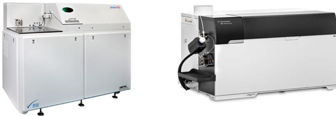
Figure 61 : les 2 nouveaux ICP-MS équipant le laboratoire LA-ICP-MS de GeoRessources : ICP-MS à secteur magnétique Attom de NU (gauche) et ICP-MS triple quadropole 8900 d'Agilent (droite)
