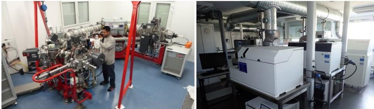
Figure 5: Gauche : microsonde ionique Cameca IMS1280-HR2 du CRPG. Le service national CNRS des sondes ioniques est équipé de deux microsondes ioniques à aimant à grand rayon de courbure. Droite : Laboratoire LA-ICP-MS de GeoRessources, équipé de deux lasers et trois ICP-MS
