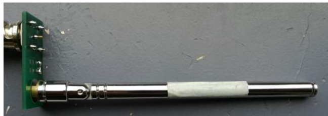
FIGURE 1.2 – Antenne fouet permettant de mesurer un champ électrique
