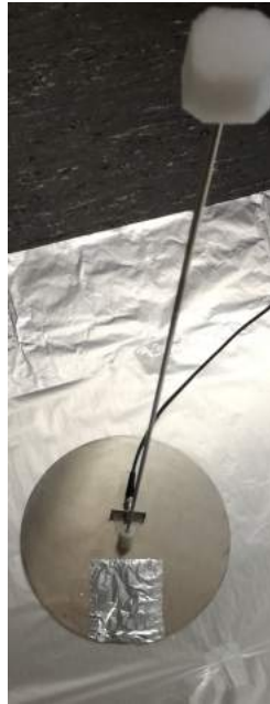
FIGURE 4.16 – Antenne fouet utilisée en émission dans le cadre de la caractérisation statique d'un individu
