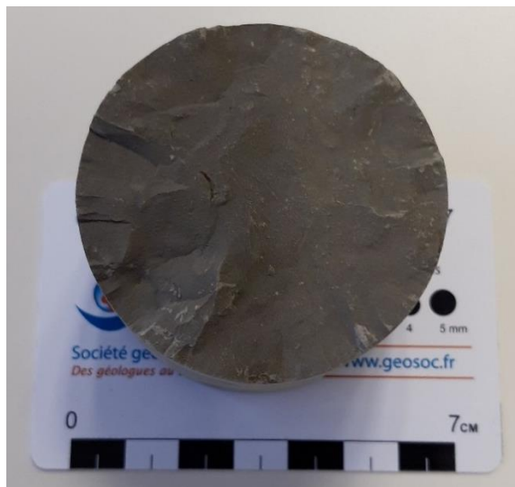
Figure III. 3 : Fragment d'une carotte d'argilite provenant de la galerie GER (COx oxydé).
