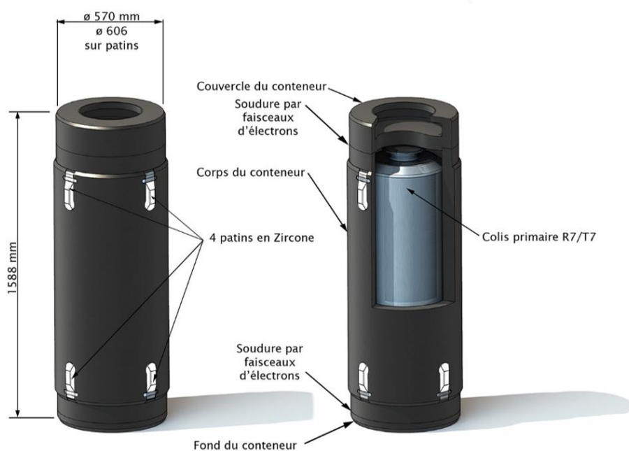
Figure 1 : schéma de concept des colis de déchets HA pour le projet Cigéo (communication Andra).
