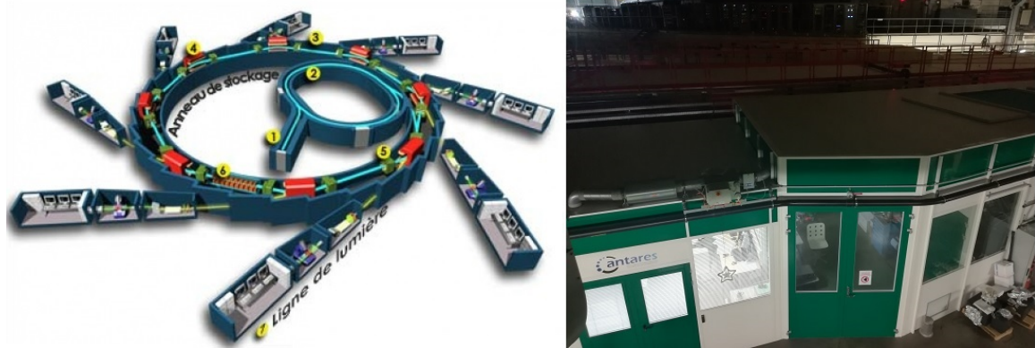
FIGURE 2.20 – (a) Principe de fonctionnement du synchrotron SOLEIL. (b) Ligne de lumière ANTARES du synchrotron SOLEIL.
