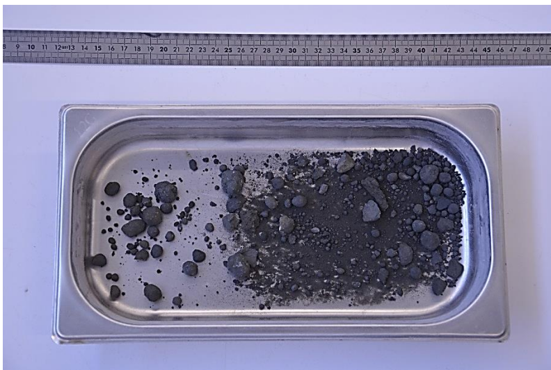
Figure 157. Aspect d'un clinker industriel
