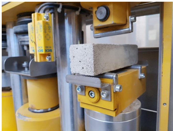
Figure 62. Dispositif d'écrasement des mortiers normalisés
