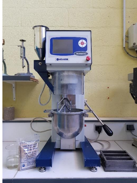
Figure 61. Matériel de laboratoire nécessaire pour la confection des éprouvettes de mortier normalisé
