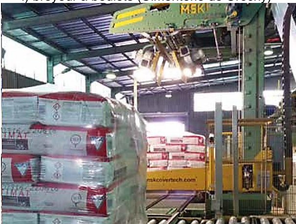
III) ensachage et palettisation du ciment
