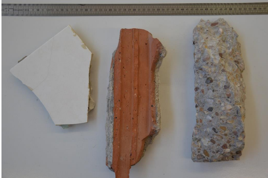
Figure 44. Déchets céramiques (fragments de cloison et de carrelage) et un bloc de béton
