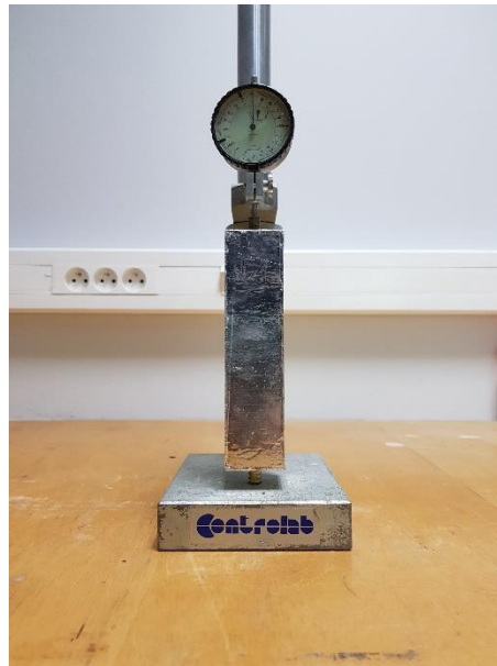
Figure 64. Éprouvette de mortier servant à la mesure du retrait endogène et appareillage de mesure des variations dimensionnelles.
