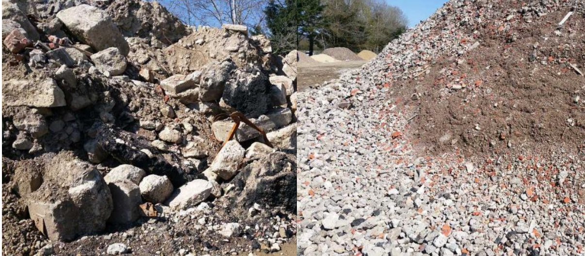
Figure 43. Déchets traités à la plateforme "Agréats du centre" à Nevers et grave recyclée produite par la plateforme (N) (Photographie : Patrice Natin, société VICAT)
