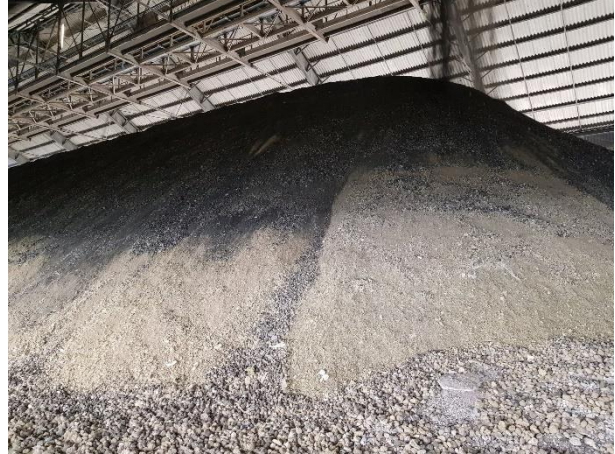
II) tas de préhomogénéisation
