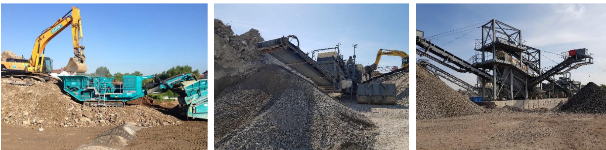
Figure 25. Exemples de stations de traitements de DCD, de gauche à droite : mobile (Le Moniteur®), semi-mobile et fixe (photographie personnelle)
