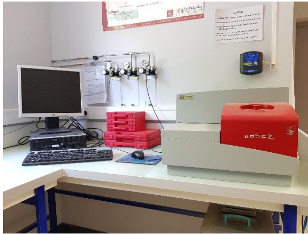
Figure 54. Micro calorimètre utilisé pour la mesure des chaleurs d'hydratation
