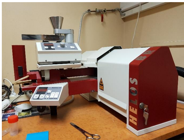
Figure 48. Granulomètre laser Sympatec Helos ®
