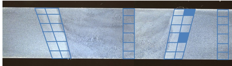
FIGURE 6.10 – Micrographie optique obtenue à la binoculaire du joint soudé attaqué chimiquement, avec une schématisation du prélèvement des répliques. Les répliques utilisées pour la comparaison entre le coeur et la surface sont représentées par un rectangle bleu plein.
