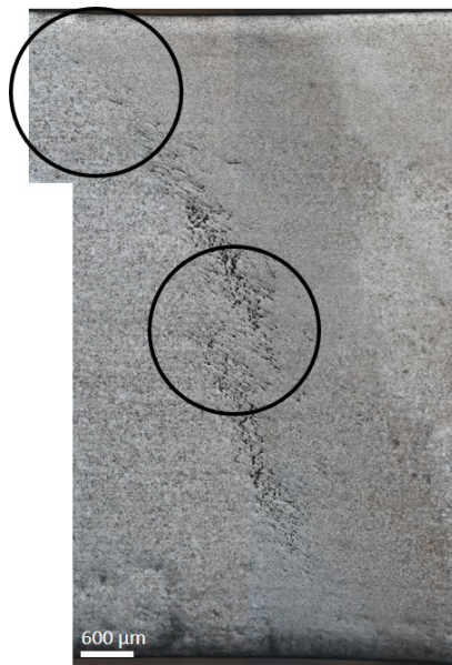
FIGURE 6.1 – Assemblage de micrographies obtenues au microscope binoculaire centrées sur la 2ème ICHAZ de l'échantillon rompu, après 5200 heures de fluage.
