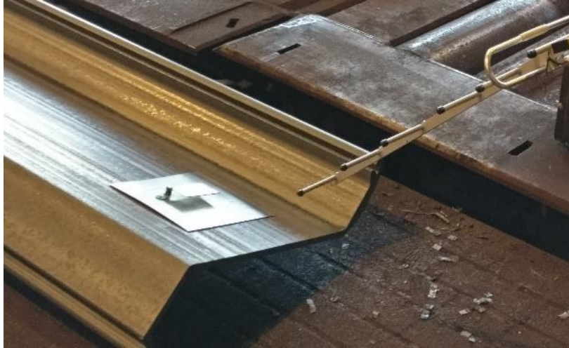
Figure 52 : Antenne PIFA et capteur SAW sous test sur une palplanche.
