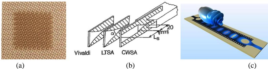
Figure 58: (a) Antenne patch microruban étirable<sup>61</sup> (b) Antennes à ondes progressives<sup>62</sup> (c) Antenne SIW à fentes<sup>63</sup>
