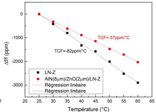
Figure 27 : (a) Coefficient de réflexion d'un dispositif AlN/ZnO/LN-Z<sup>5</sup> (c) TCFs d'un dispositif LN-Z et AlN/ZnO/LN-Z<sup>5</sup>
