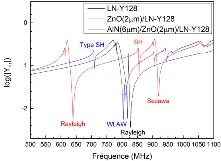
Figure 13 : Module de l'admittance  $|Y_{11}|$  de la structure AlN/ZnO/LN-Y128 aux différentes étapes <sup>5</sup>
