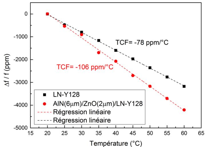
Figure 15 : Coefficient température-fréquence (TCF) du LN-Y128 et de la structure AlN/ZnO/LN-Y128 pour les ondes de type Rayleigh<sup>5</sup>
