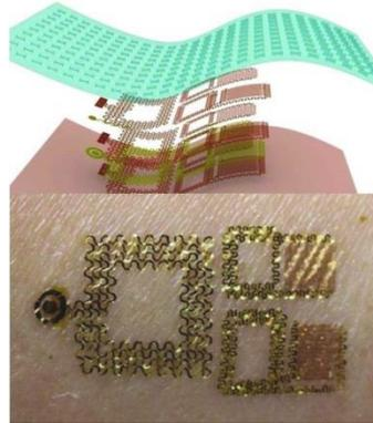
Figure 4 : Capteur d'hydratation et de contrainte [R6]
