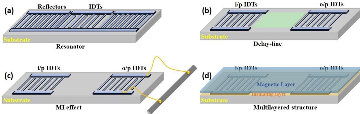
Figure 36 : Différentes configurations de capteurs MSAW<sup>38</sup> (a) Résonateur (b) Lignes à retard (c) Magnétoimpédance (d) Multicouches
