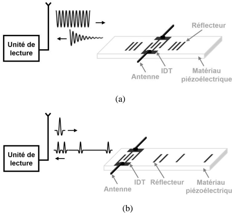
Figure 6 : (a) Résonateur en configuration sans fil (b) Ligne à retard réflective (R-DL) en configuration sans fil <sup>5</sup>
