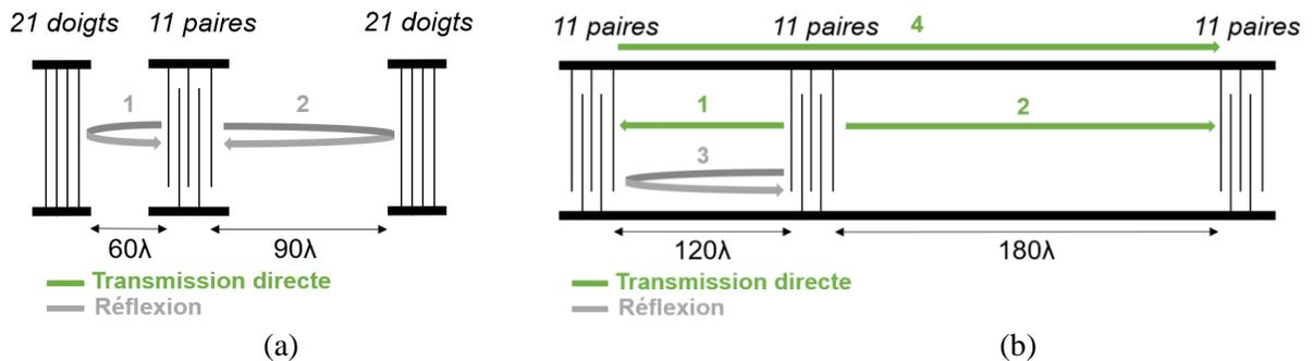
Figure 46 : (a) Ligne à retard classique (b) Ligne à retard de type « IDT connectés »<sup>5</sup>
