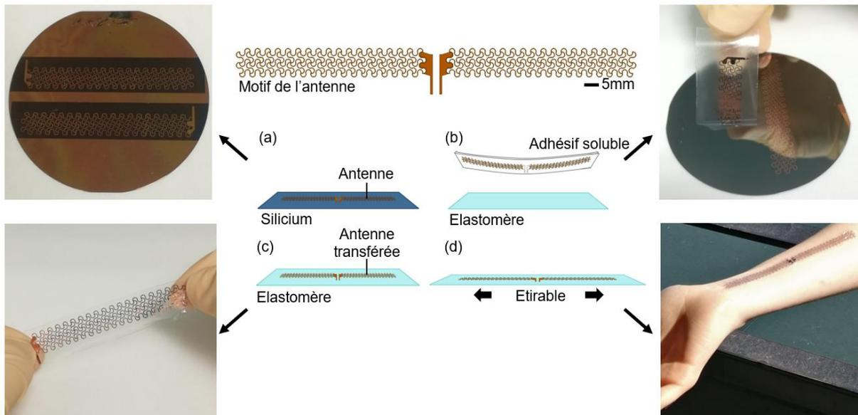
Figure 31 : Principales étapes du procédé de fabrication des antennes étirables <sup>5</sup>
