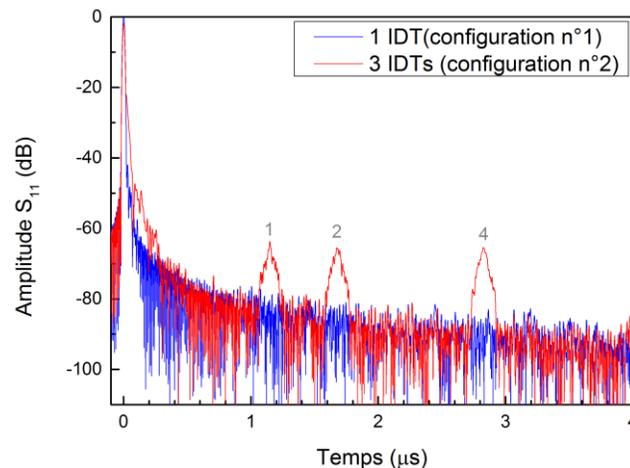
Figure 48 : Coefficients de réflexion expérimentaux dans le domaine temporel d'une structure R-DL standard (1IDT) vs IDT connectés (3IDT) sur LGS <sup>5</sup>
