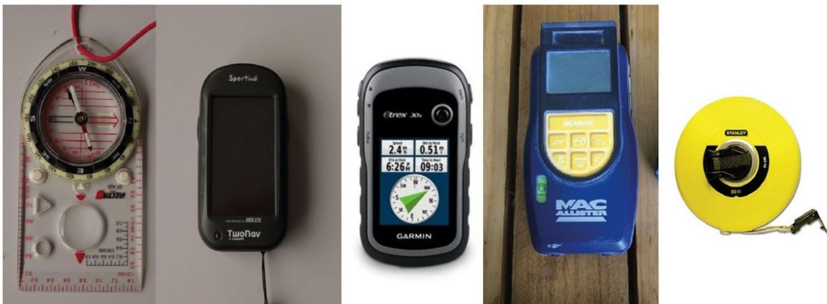
Photo 4.1 – Les différents outils nécessaires au travail de terrain (de gauche à droite : Boussole à clinomètre, GPS à main TwoNav Sportiva et Garmin Etrex 30x, télémètre laser et triple décimètre) (cliché : Bensaadi, 2017)
