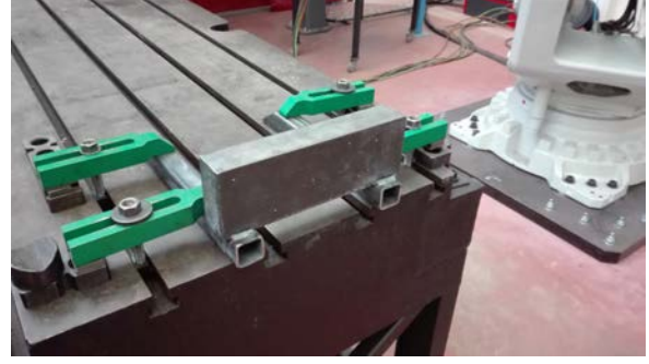
FIGURE 4.9: Prisme utilisé pour essai MA
