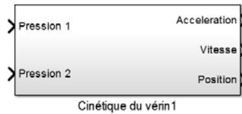
FIGURE 2.19: Bloc de calcul de la cinétique du piston du vérin pneumatique
