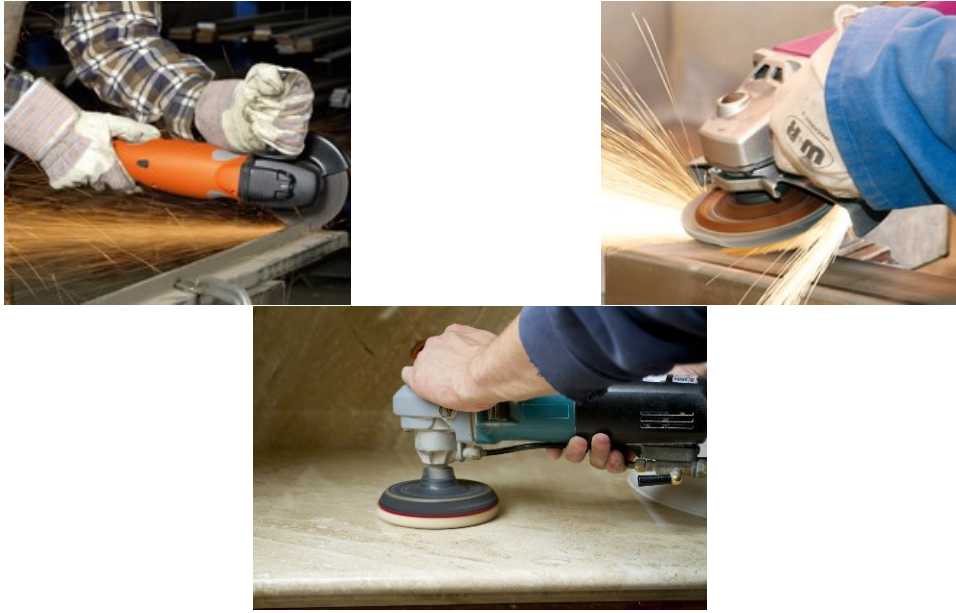
FIGURE 1.32: Applications de la meuleuse angulaire : Tronçonnage ; Surfaçage ; Polissage.
