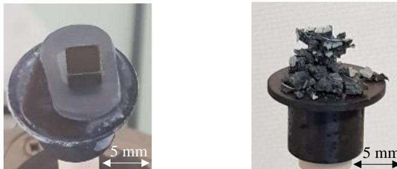
Figure IV- 45: Photos des alliages  $\text{Mg}_2\text{Si}_{0.9}\text{Sn}_{0.1}$  chauffé jusqu'à 850°C sous air (à gauche) et  $\text{Mg}_2\text{Si}_{0.6}\text{Sn}_{0.4}$  chauffé jusqu'à 510°C sous air (à droite)
