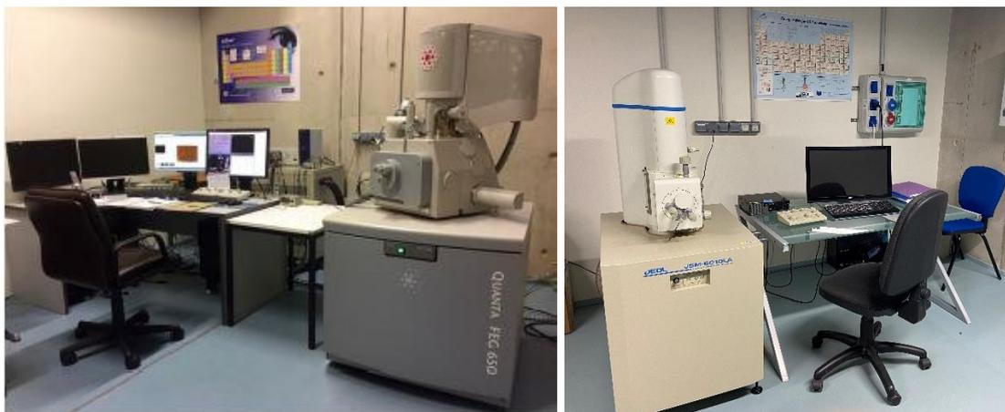
Figure II- 18 : Microscopes électroniques à balayage JEOL JSM-6010LA (à droite) et QUANTA 650 FEG (à gauche)
