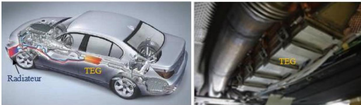
Figure I-6 : Concept d'une BMW 530i avec un générateur thermoélectrique produisant de l'électricité à partir de la chaleur perdue au niveau de pot d'échappement [33], [44]
