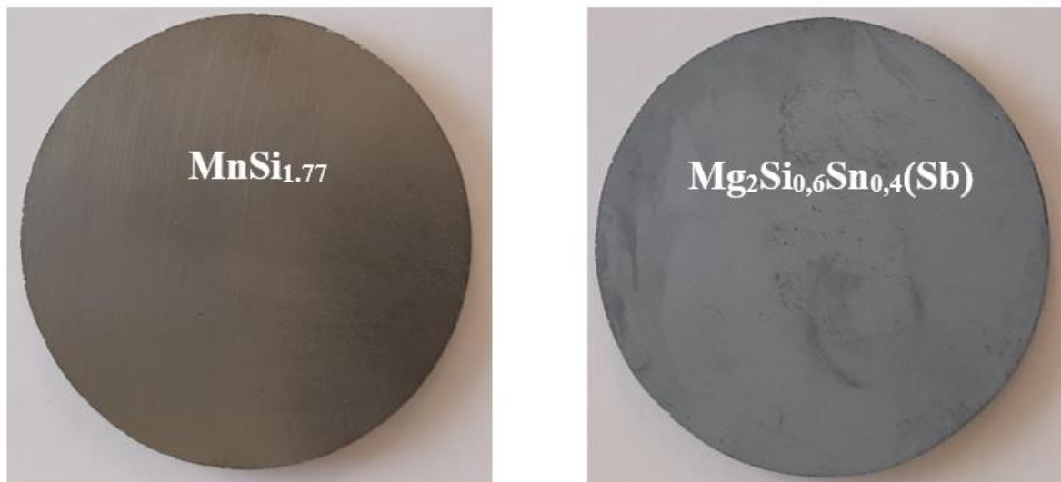
Figure II- 5: Galettes de \text{MnSi}_{1,77} et de \text{Mg}_2\text{Si}_{0,6}\text{Sn}_{0,4} après rectification et nettoyage. Le diamètre et l'épaisseur sont de 60 et 4,6 mm, respectivement.
