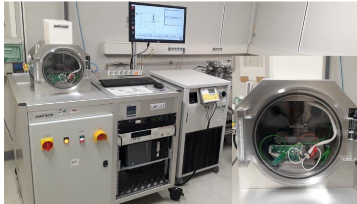
Figure III- 2: Photo du banc de mesure des performances des modules du CEA. Dans le coin inférieur droit se trouve un agrandissement de la chambre de mesure
