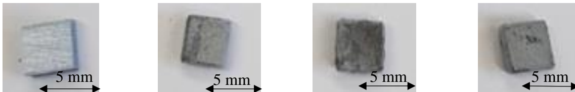
Figure V- 37: Photos de cubes d'alliage Mg_2Si_{0,9}Sn_{0,1} initial et revêtus d'aluminium par pack cémentation sous vide secondaire et recuits à 500°C pendant 30 min, 60 min et 120 min (de gauche à droite)
