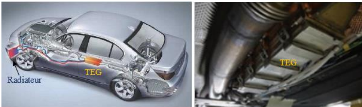
Figure I-6 : Concept d'une BMW 530i avec un générateur thermoélectrique produisant de l'électricité à partir de la chaleur perdue au niveau de pot d'échappement [33], [44]
