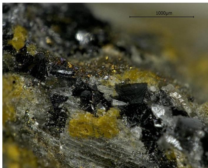
**Figure 27.** Image sous la binoculaire de cristaux naturels de cronstedtite (noirs) provenant de la mine de Salsigne, mélangés à des sulfures et des carbonates.
