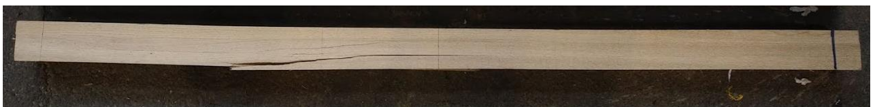
Figure 3.45 : Mode de rupture des poutres collées
