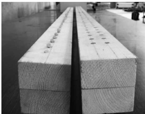
Figure 2.36 : Poutres tourillonnées assemblées par soudage rotatif des tourillons en bois de hêtre (Bocquet et al. [51])
