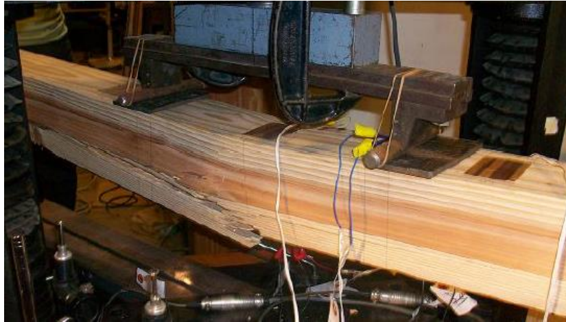
Figure 2.21 : poutres lamellées collées renforcée par des blocs en bois densifié sous flexion 4-points [37]
