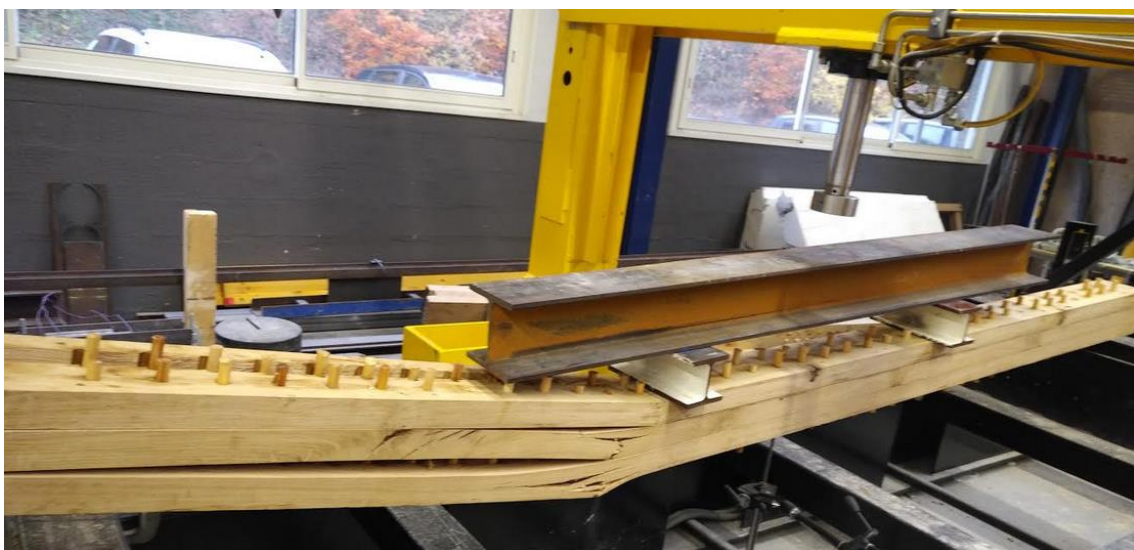
Figure 3.59 : Mode de rupture de la poutre tourillonnée PT-D
