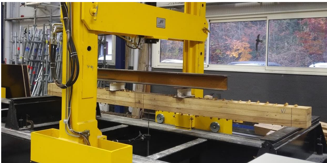
Figure 3.53 : Montage expérimental des tests de flexion 4-points pour les poutres à grande échelle
