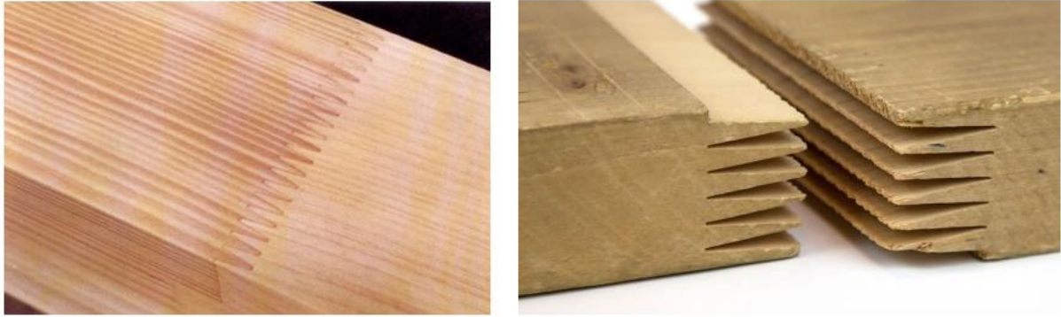
Figure 1.3 : Aboutage des lamelles par entures multiples
