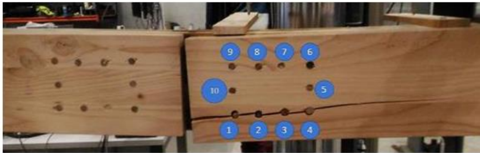
a) Assemblage avec plaque et tourillons en bois densifié
