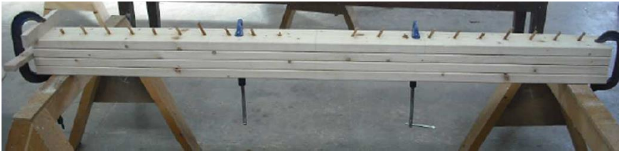
Figure 2.37 : Poutre lamellée tourillonnée assemblée par soudage rotatif de tourillons en hêtre (O'Loinsigh et al [52])
