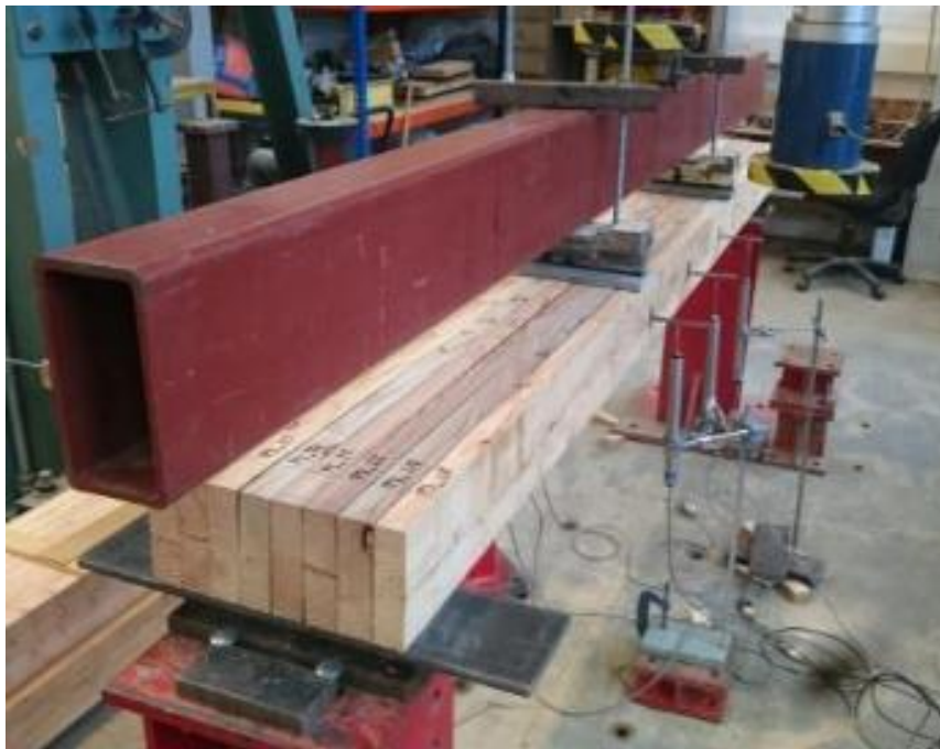
Figure 2.35 : Tests de flexion réalisés par Plowas et al. [50]
