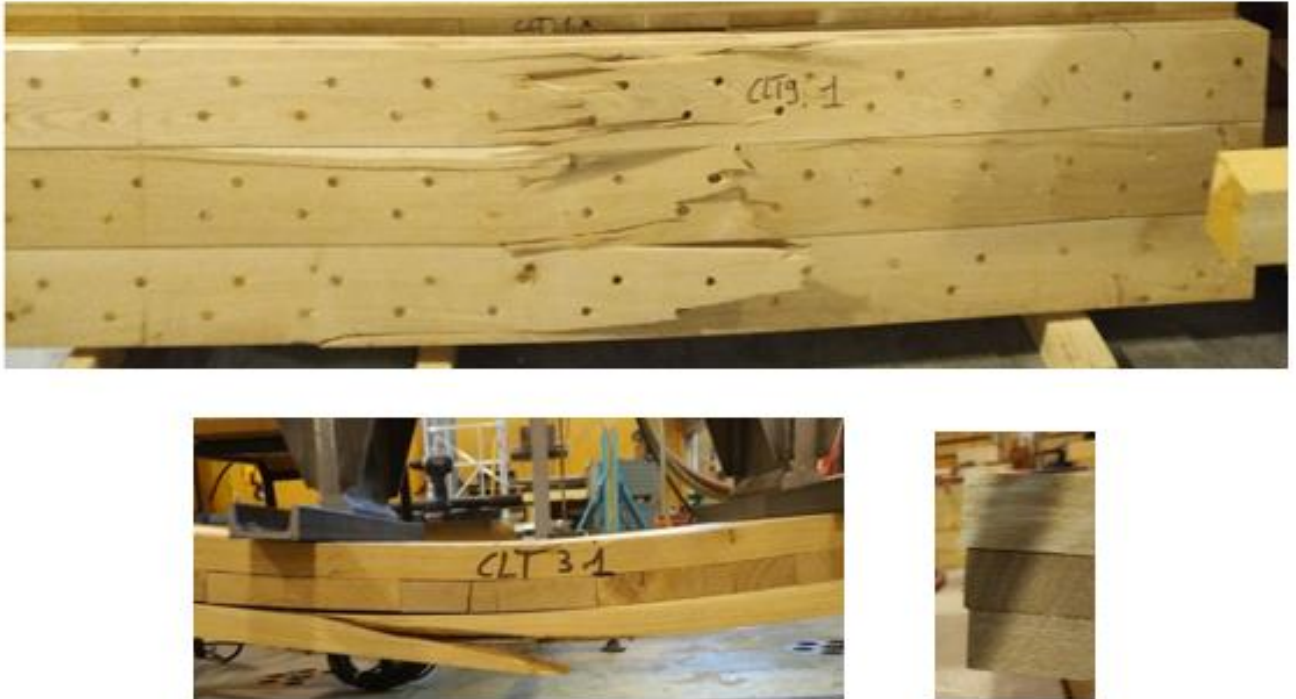
Figure 3.68 : Mode de rupture des panneaux CLT en flexion 4-point
