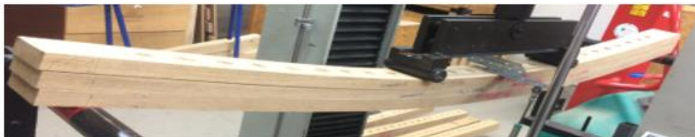
Figure 3.42 : Dispositif expérimental des tests en flexion 4-points
