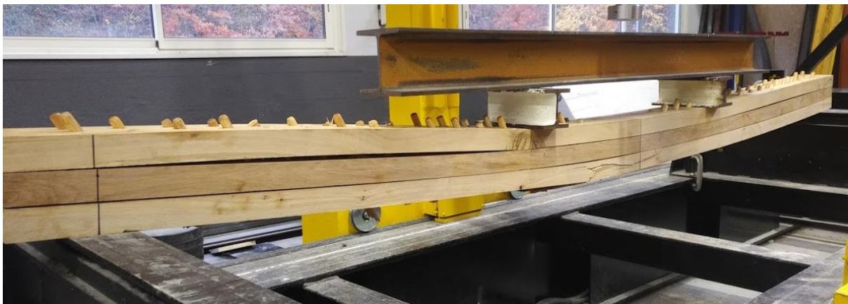
figure 3.60 : Mode de rupture de la poutre PT-X
