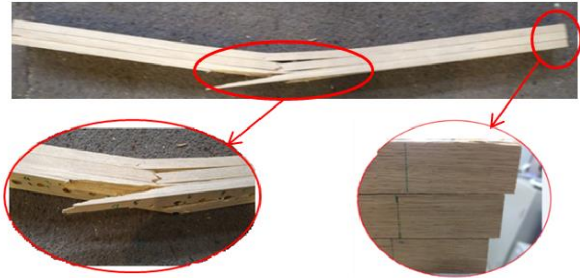
Figure 3.46 : Mode de rupture des poutres tourillonnées (PT)
