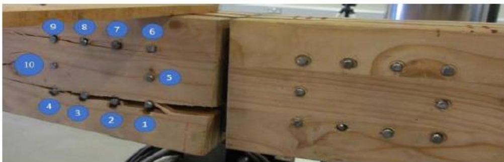
b) Assemblage avec plaque et broches métalliques
