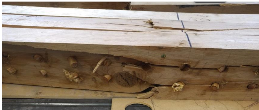
figure 3.60 : Mode de rupture de la poutre PT-X
