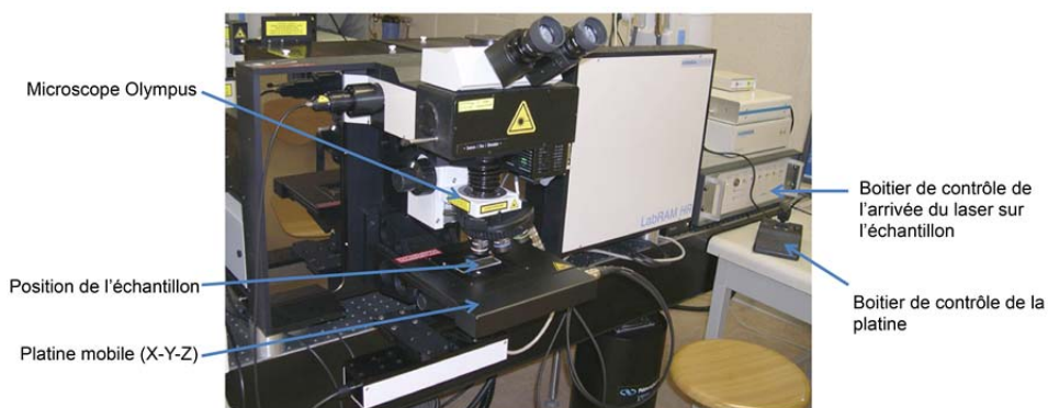
Figure 2.17: Photo du spectromètre Raman LabRAM HR (Horiba Jobin Yvon) utilisé au cours de cette thèse (photo provenant du site du laboratoire GeoRessources).
