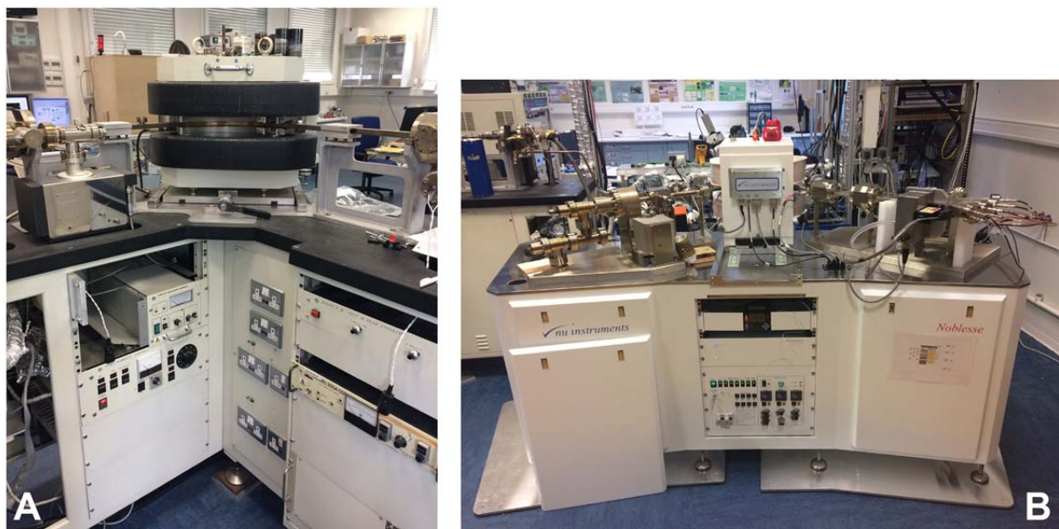
Figure 2.27: Photos des deux spectromètres de masses gaz rares utilisés durant cette thèse avec (A) le VG-5400 et (B) le Noblesse HR.
