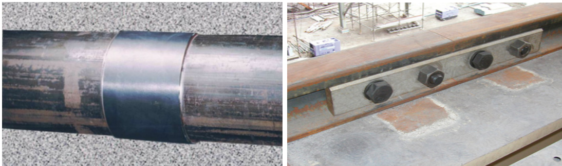
(a) Bague de serrage en AMF base Fer pour la connexion de tubes (b) Eclisse en AMF base Fer pour la jonction des rails
