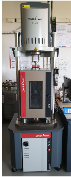
(a) Machine de traction uni-axiale Zwick® LTM1 avec sa chambre thermique.
