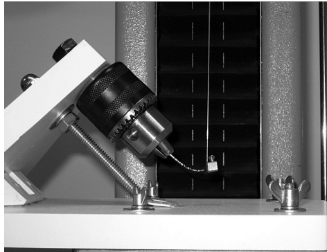
(a) Etude de la force de flexion générée par une lime endodontique lorsque sa pointe est fléchie avec un câble en traction (Scelza et al., 2015)
