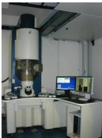
Figure II-30 : Microscopie électronique en transmission ARM 200 cold FEG.
