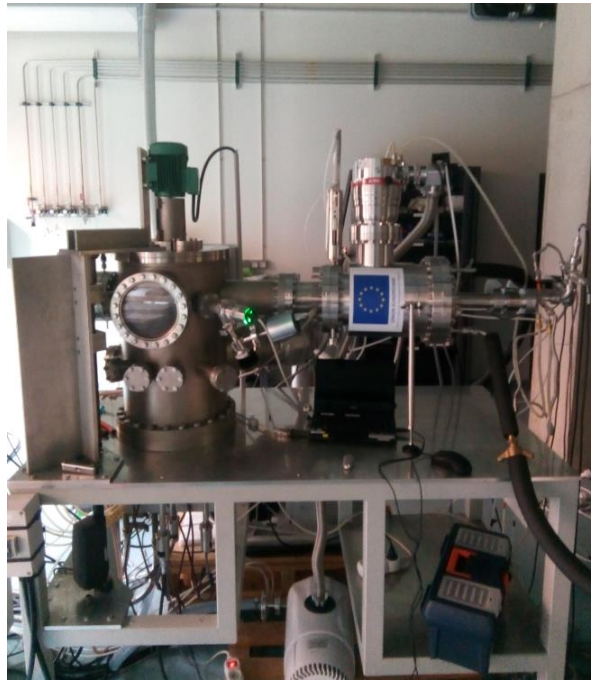
Figure II-12 : Réacteur 3 magnétrons couplé à une source de « nanoclusters ».
