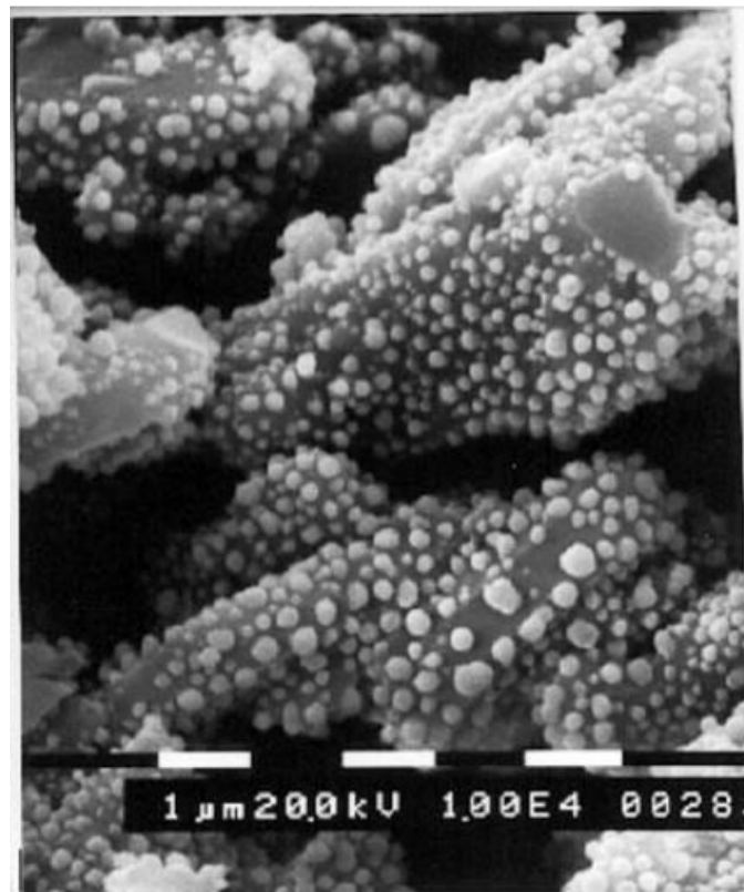
Figure I-2 : Micrographie MEB d'un catalyseur industriel d'argent supporté sur de l'alumine alpha [10].
