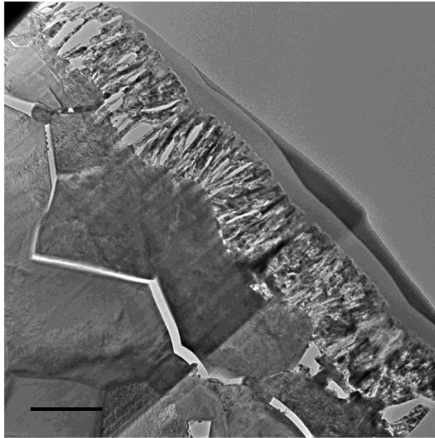
Figure II-34 : Image MET d'une lame FIB extraite d'un film Ag/CGO 4 Pa 70 mA déposé sur pastille de CGO.
