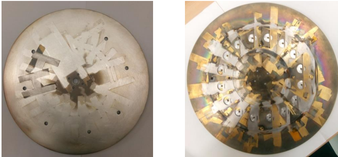
Figure II-14 : Photos des porte-substrats pour dépôt sur silicium (gauche) et sur pastilles CGO/YSZ (droite).
