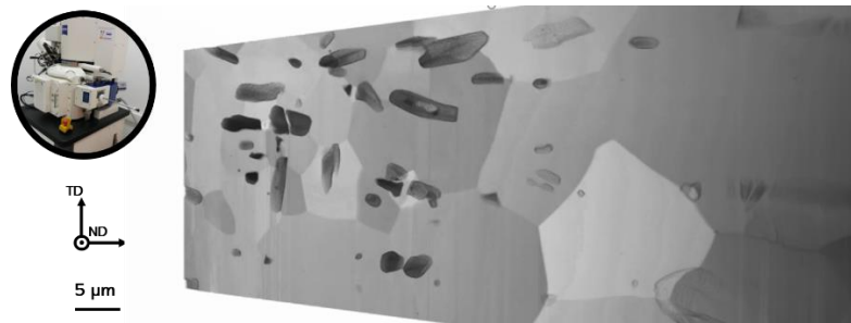
Figure 3.12 : Reconstruction 3D de la microstructure du composite à matrice ferritique renforcée par des particules de TiB 2 (Auriga 40 FIB-SEM - Volume : 60x30x30 µm – Images acquises avec le détecteur InLens - Taille de Voxel : 50nm)
