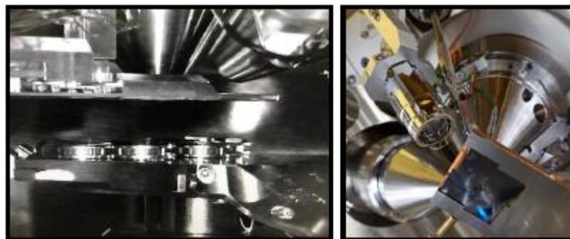
Figure 1-26 : Deux vues d'un détecteur EBSD dans une configuration sans inclinaison.
