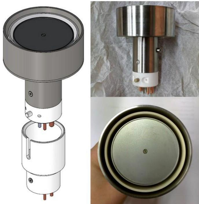
Figure II-3 : Schéma et photos vue de dessus et de profil du porte substrat
