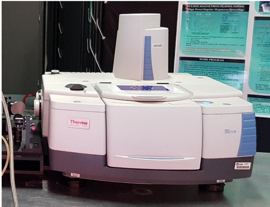
Figure II-9 : Photo du spectromètre FTIR *ThermoScientific Nicolet iS50*.
