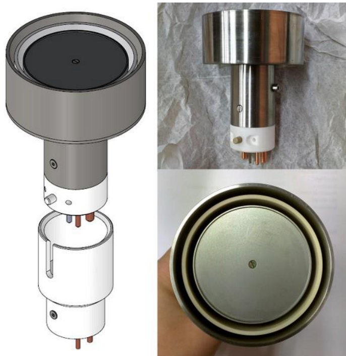
Figure II-3 : Schéma et photos vue de dessus et de profil du porte substrat
