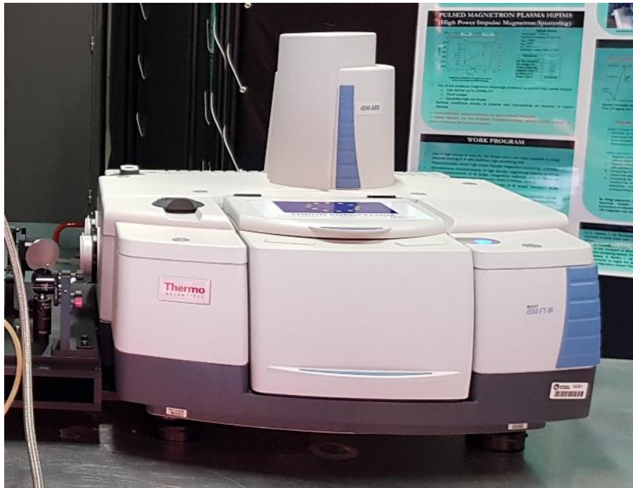
Figure II-9 : Photo du spectromètre FTIR ThermoScientific Nicolet iS50 .
