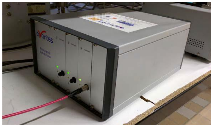
Figure II-13 : Photographie du spectromètre visible Avantes
