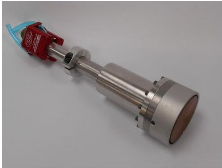
Figure II-7 : Photo du magnétron utilisé dans cette étude
