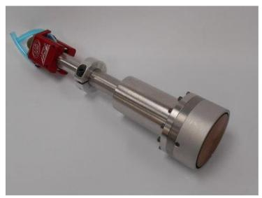
Figure II-7 : Photo du magnétron utilisé dans cette étude
