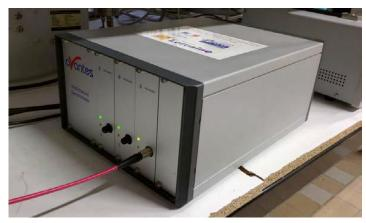
Figure II-13 : Photographie du spectromètre visible Avantes
