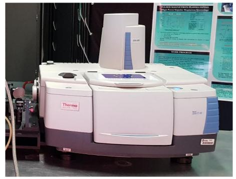
Figure II-9: Photo du spectromètre FTIR ThermoScientific Nicolet iS50.
