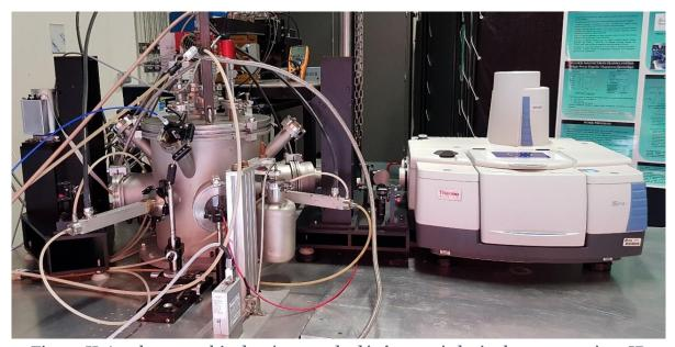
Figure II-1 : photographie du réacteur de dépôt avec à droite le spectromètre IR utilisé pour cette étude.
