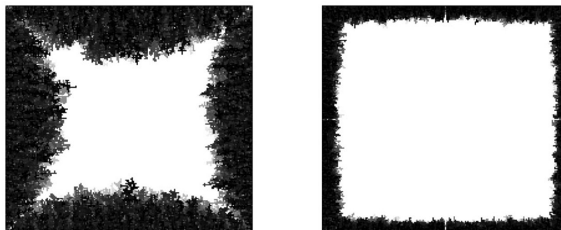
Figure 24 : Croissance d'un dépôt de suie pour un Péclet de 0,1 à gauche contre un Péclet de 100 à droite pour une même masse de gâteau déposée (Rodríguez-Pérez et al. 2004)
