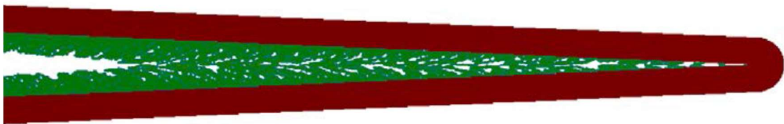
Figure 28 : Formation du dépôt à une vitesse de filtration de 2,34 cm.s -1 dont la masse déposée est de 204 g.m -2 (Alilou 2018)
